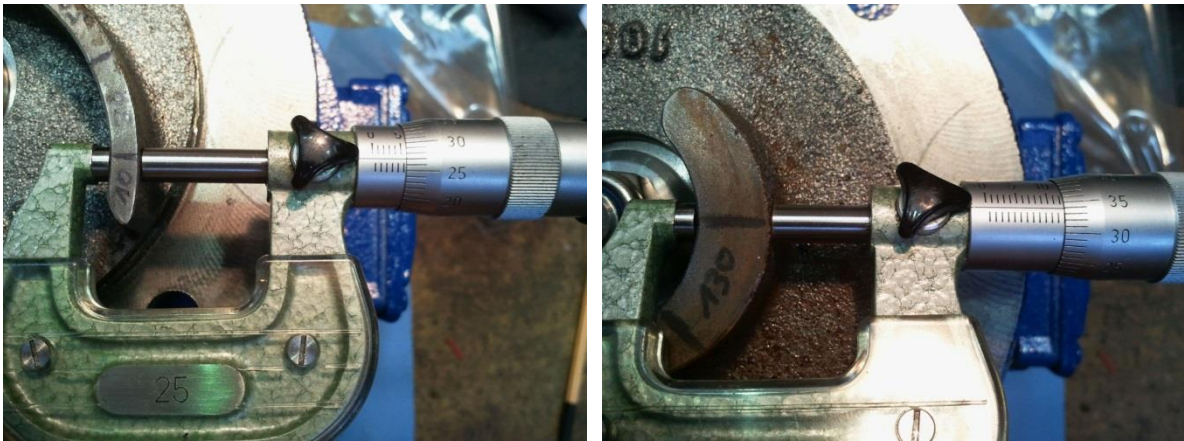
Bild 3-5: Vermessung der Laufradschaufel an den Messstellen „10 mm“ (links) und „130 mm“ (rechts) vor Versuchsbeginn
