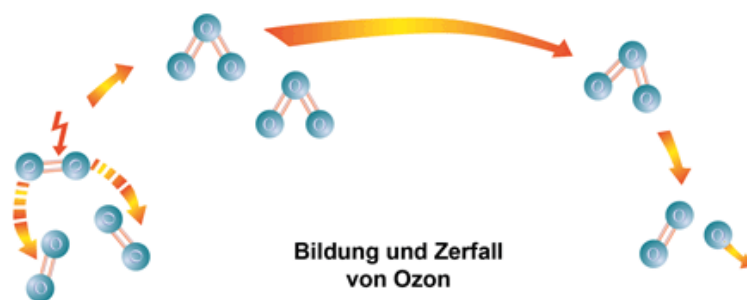
Abb. 5-6: Bildung/Zerfall von Ozon (vereinfachte schematische Darstellung) [65]
