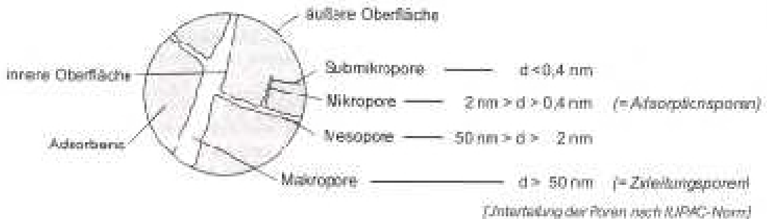
Abbildung 5-7: Schematische Porenstruktur von Aktivkohle (Metzger, 2010)
