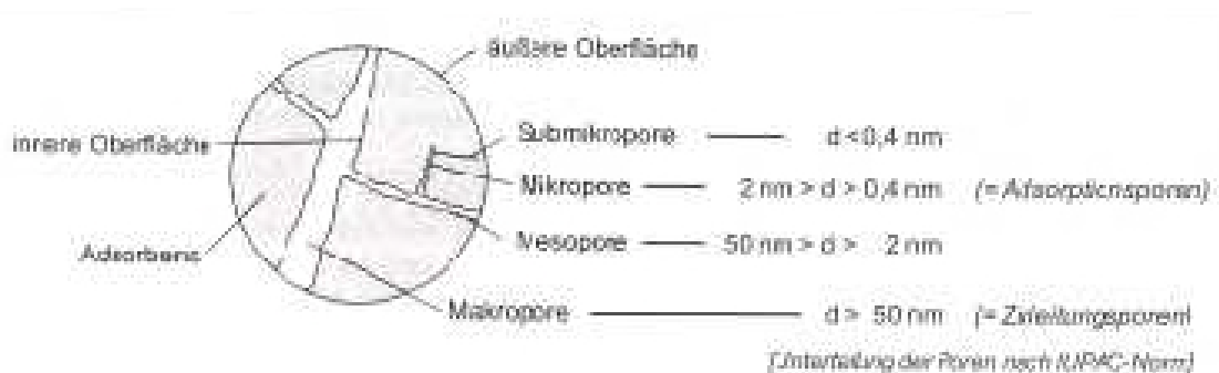
Abbildung 5-7: Schematische Porenstruktur von Aktivkohle (Metzger, 2010)
