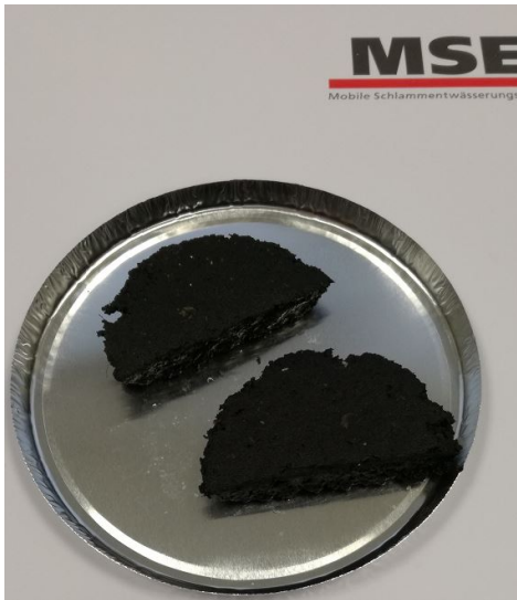
Abbildung 9-1: Filterkuchen von der Laborentwässerung mit Trockengut als Strukturmittel und das dabei entstandene feststofffreie Filtrat
