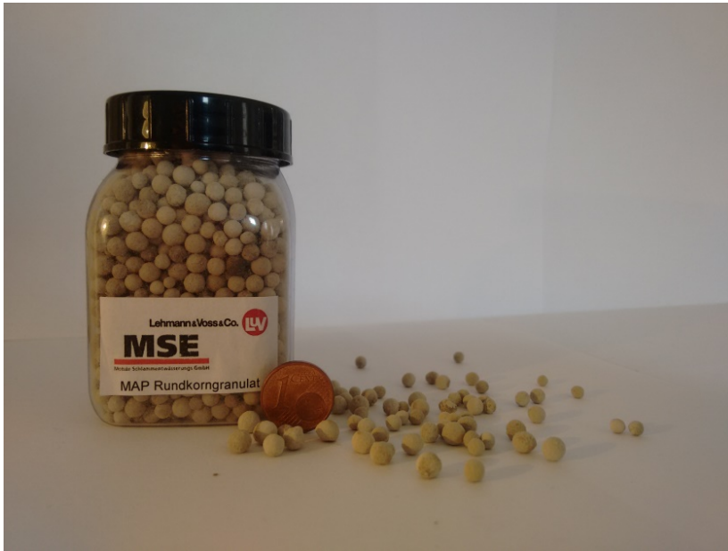
Abbildung 8-3: Granuliertes Struvit – Düngeprodukt (links) ; Granulat aus Struvit Düsseldorf (rechts)
