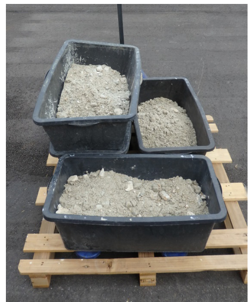
Abbildung 4-12: Struvit (feucht und dunkel, links) gegenüber Struvit (trocken und grau, rechts); abgetrenntes Struvit aus Düsseldorf
