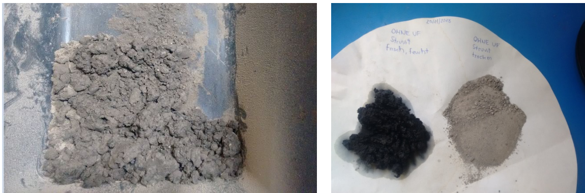
Abbildung 7-5: Struvit (aus Filtrat) entwässert mit Zentrifuge ; Struvit aus Filtrat (ohne UF) entwässert mit Zentrifuge: feucht, dunkel vs. getrocknet, grau
