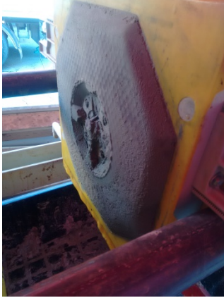
Abbildung 3-6: Entwässertes Struvit in der Kammerfilterpresse, Struvit-Kristalle unter dem Mikroskop
