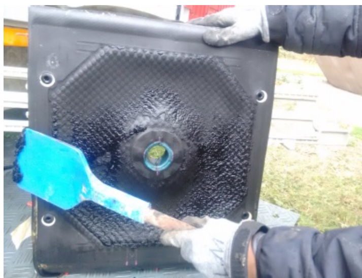
Abbildung 7-4: Struvit aus Filtrat (ohne UF) in Imhoff-Trichter, Filtertuch verblockt durch Struvit aus dem Filtrat (ohne UF)
