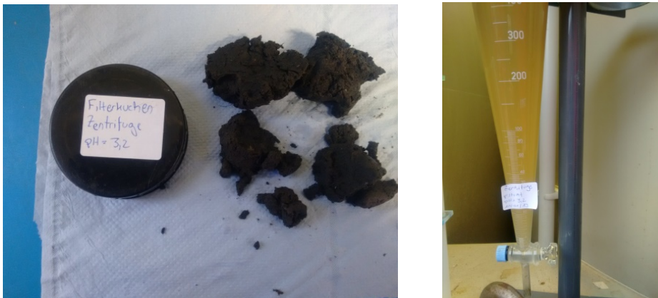
Abbildung 7-3: Filterkuchen + Filtrat Zentrifugen Entwässerung, pH-Wert Ansäuerung = 3,2
