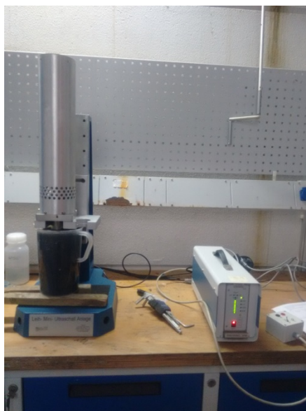
Abbildung 3-7: Vorrichtung zur Desintegration von Faulschlämmen mit Ultraschall
