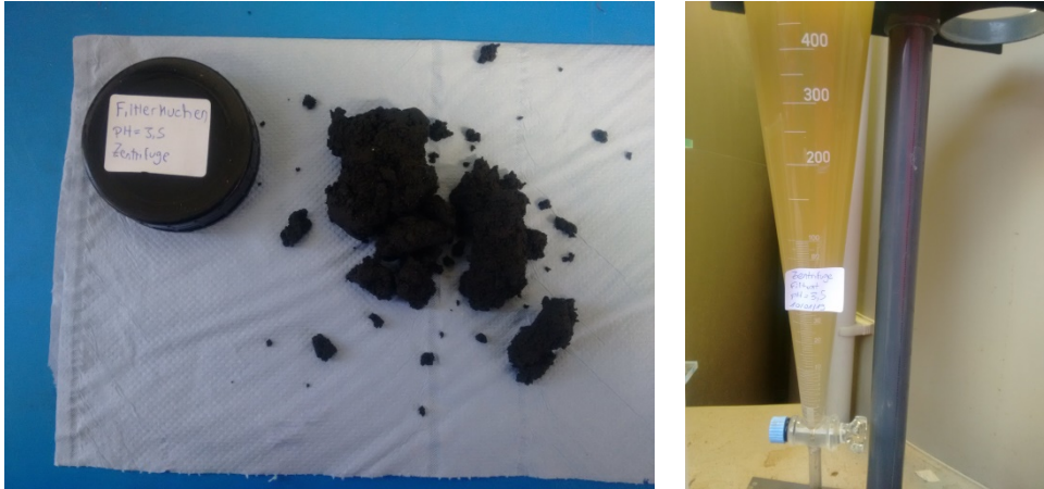
Abbildung 7-2: Filterkuchen + Filtrat Zentrifugen Entwässerung, pH-Wert Ansäuerung = 3,5
