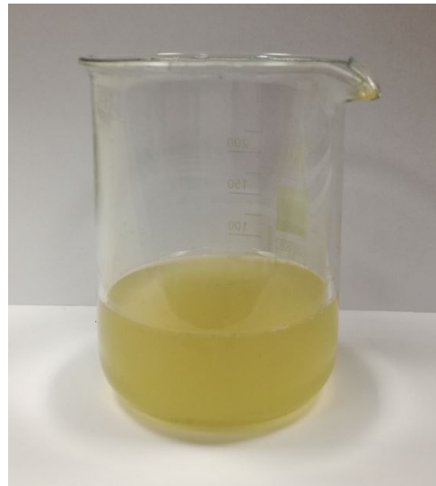
Abbildung 9-1: Filterkuchen von der Laborentwässerung mit Trockengut als Strukturmittel und das dabei entstandene feststofffreie Filtrat
