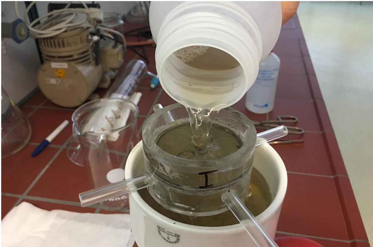
Abbildung 8: Abscheidung der Fraktion AFS<sub>grob</sub> mittels aufgesetztem Sieb
