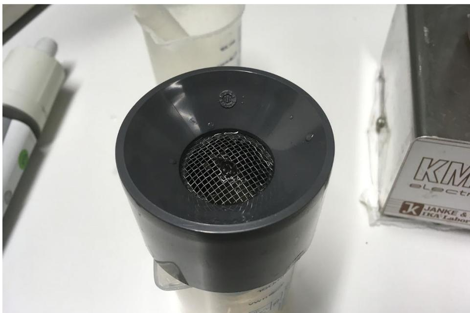
Abbildung 12: Verwendetes Sieb (Maschenweite ca. 2 mm) bei der Vorbereitung der Probe für die Messung mittels Laserbeugung
