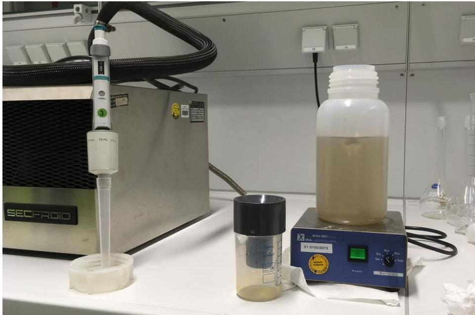
Abbildung 11: Probenhandlung bei der Bestimmung der Partikelgrößenverteilung;
