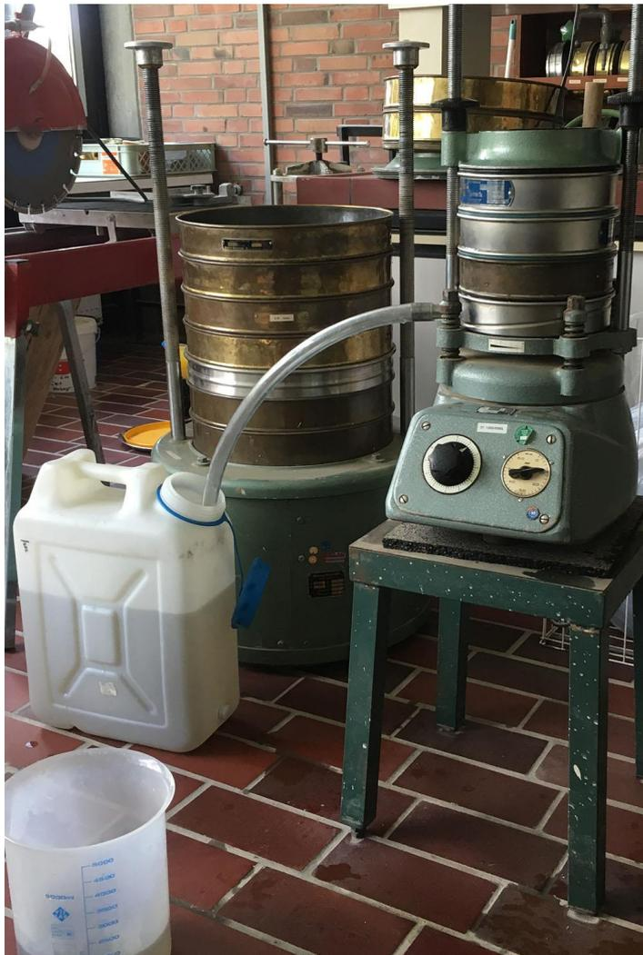
Abbildung 13: Nasssiebung ausgewählter Proben
