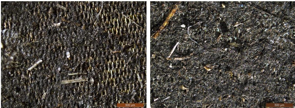
Abbildung 64: Feststoffe aus Niederschlagswasserproben auf  $10 \mu\text{m}$ -Sieb (Vergrößerung 50x)
