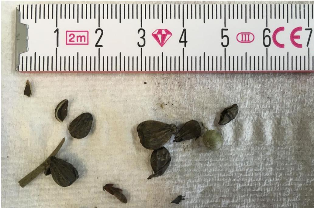
Abbildung 9: Beispiel für aussortierte Bestandteile der Fraktion AFS<sub>grob</sub>
