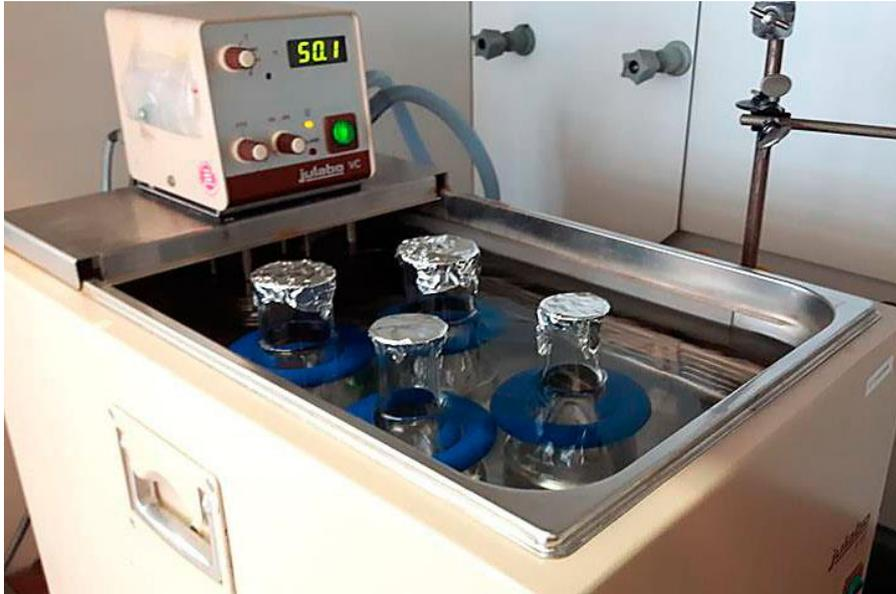
Abbildung 18: Temperierbad mit Proben der Oxidationsversuche
