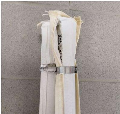
Die Filtermaterialien der Scheiben- und Beutelfilter wurden ebenfalls am Ende der Betriebsphase 2021 untersucht. Der Scheibenfilter zeigte optisch keine Ablagerungen und Schäden. Beim Beutelfilter wurden allerdings Risse im Filtermaterial festgestellt (Abbildung 4-9).
