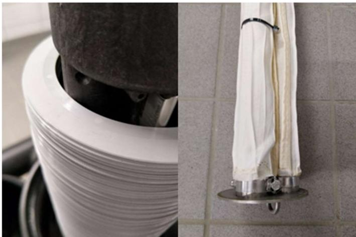
Beutelfilter mit dem abgereinigten Prozesswasser zurückgespült. Die maximale Druckdifferenz zur Rückspülung des Scheibenfilters wird im Regelbetrieb nicht erreicht, so dass dieser automatisch stündlich zurückgespült wird. Beide Mikrosiebe werden von außen nach innen mit Prozesswasser durchströmt.
