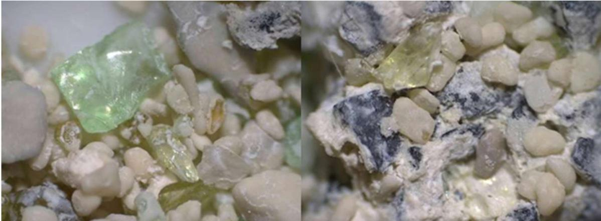
**Abbildung 4-8** Filtermaterial des Tiefenfilters mit Ablagerungen: AFM (links), Quarzsand (rechts)
