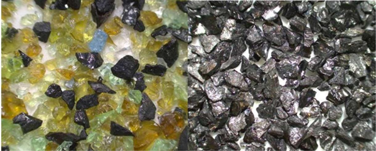
**Abbildung 3-2** Filtermaterial AFM® (links) und Quarzsand (rechts)
