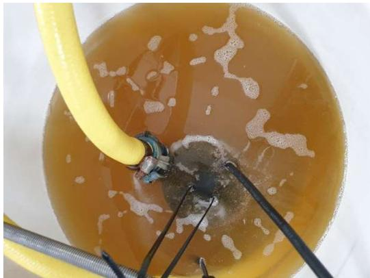
**Abbildung 4-14** Membranreinigungslösung „Mem-OT“ nach Reinigung der Membrankontakten
