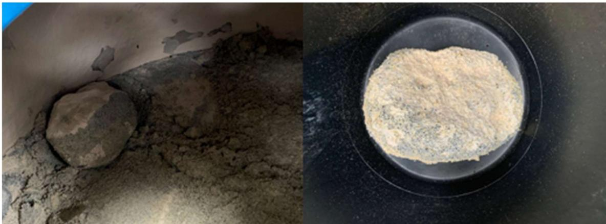
**Abbildung 4-7 Tiefenfiltermaterial nach dem Betriebszeitraum (01.10.2020-16.05.2021)**
