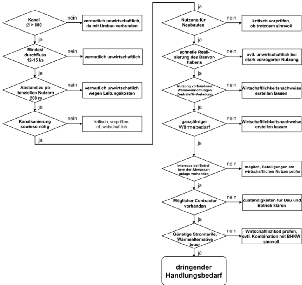
Bild 5-7: Zusammenstellung von Auswahlkriterien für geeignete Standorte für Abwasserwärmenutzungsanlagen (Klinger, Weber 2004)
