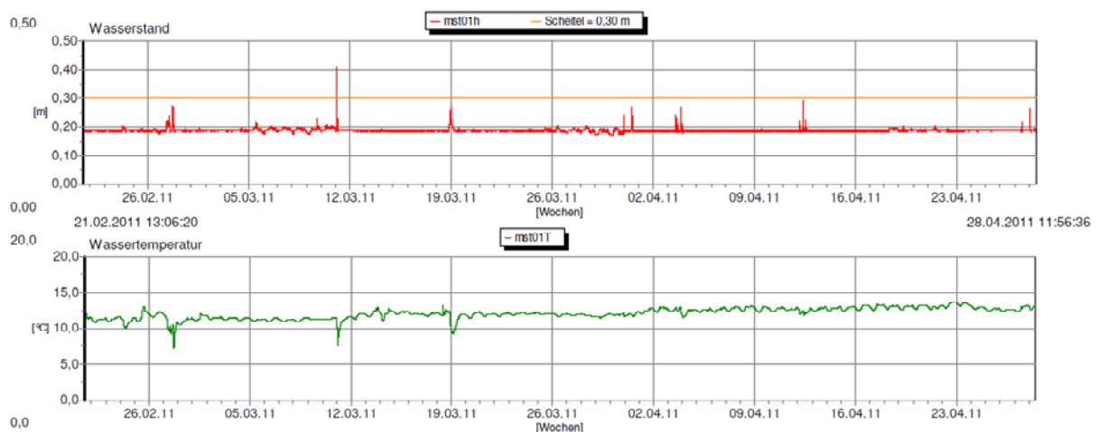
Bild 3-32: Wasserstand und Abwassertemperatur an der Messstelle im Marbachkanal
