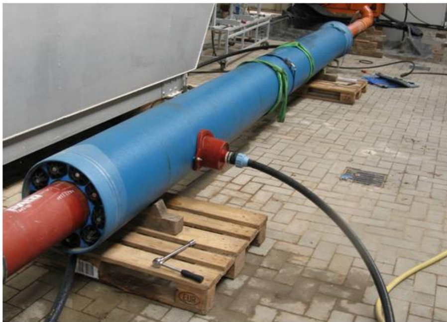
Bild 3-25: Entwicklung von doppelten Gussrohren für den Einsatz der Wärmeentnahme im Trink- und Abwasserbereich (Saint-Gobain)
