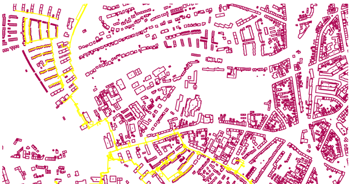
Bild 5-10: Grundkarte Aachen (Gebäudebestand) mit Fernwärmenetz (gelb) (FiW, 2009)
