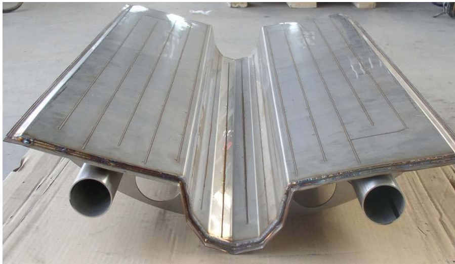
Bild 3-14: Kanalwärmetauscher Form A (Fa. Uhrig GmbH, Geisingen)
