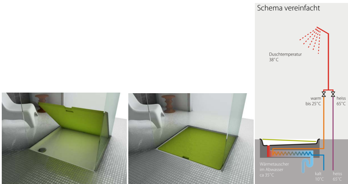
Bild 3-12: Die Dusche mit Wärmerecycling (Joulia SA, Biel (CH))
