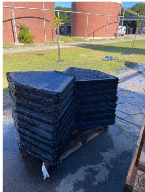
**Abb. 26:** Gereinigte Tuchfiltersegmente
