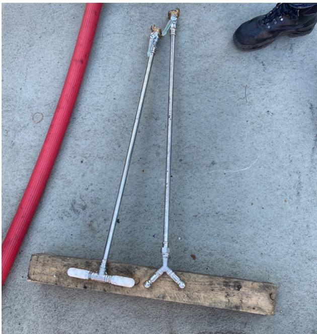
**Abb. 25:** Unterschiedliche Lanzen für Reinigung der Tuchfilter
