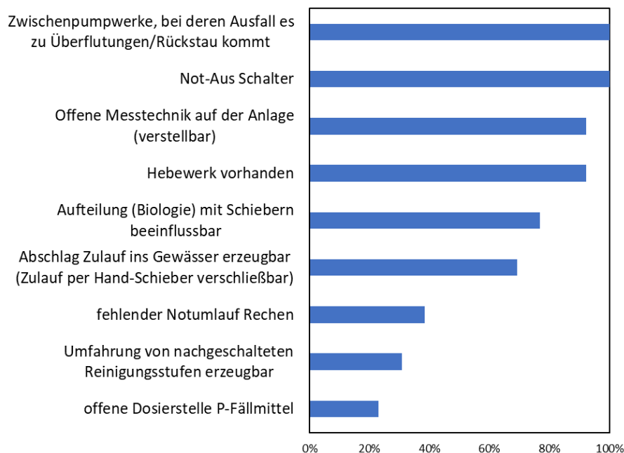
Abbildung 3-26: Anteil an Kläranlagen, mit abwasserwirtschaftlich problematischen Angriffspunkten.
