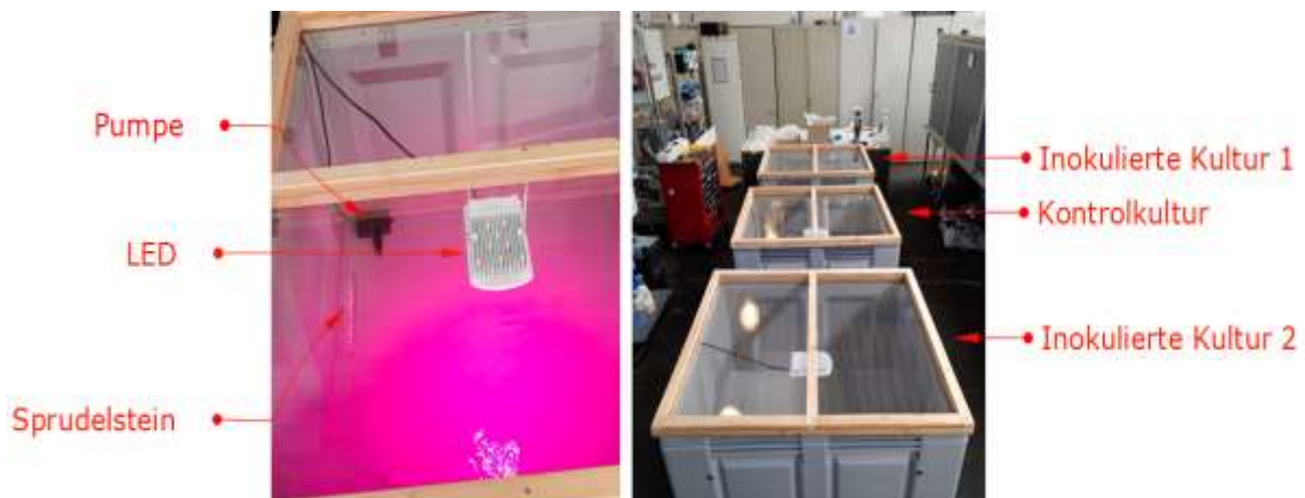
Abbildung 56: A) Begasung, Pumpe und Beleuchtung im IBC-Versuch; B) Grundlegender Versuchsaufbau der IBC-Suspensionskulturen (Versuch 3)
