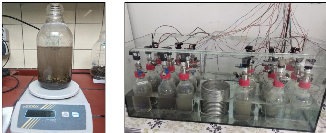
Abbildung 30: Ansatz grobkörniges Zeolith (links) und Batch-Reaktoren im Wasserbad (rechts)
