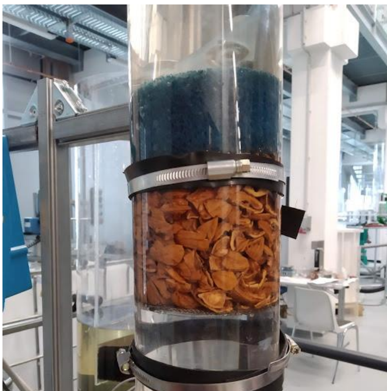
Abbildung 22: Mit Walnussschalen gefüllte Filtersäule, oberhalb der Filterschüttung ist eine Filtermatte zur Verhinderung des Materialaustrags installiert
