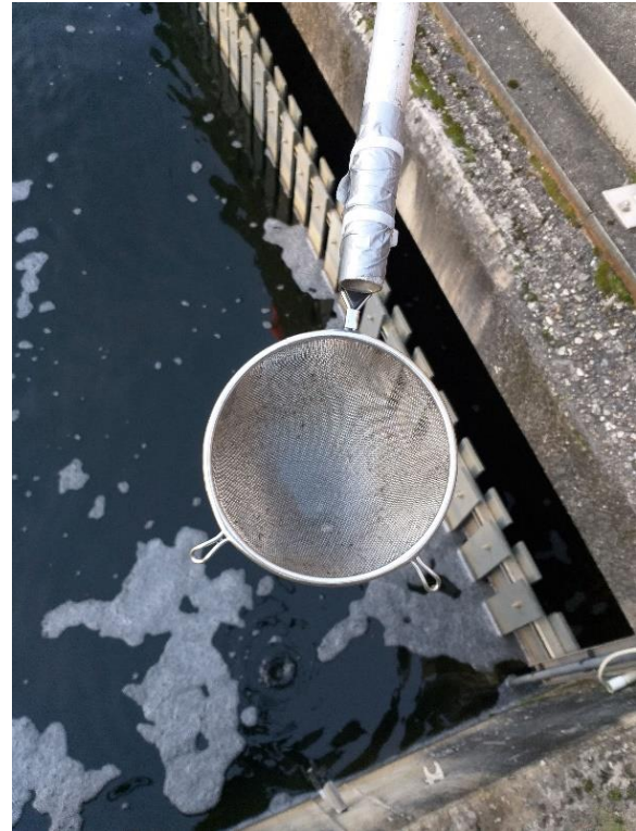
Bild 75: Sieb ohne Aktivkohle nach Einbau der Entlüftungsleitung
