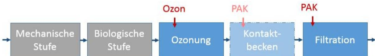
**Abbildung 5-11: Schematische Darstellung der Verfahrenskombination Ozonung und PAK-Dosierung (KOM-M.NRW, 2016)**
