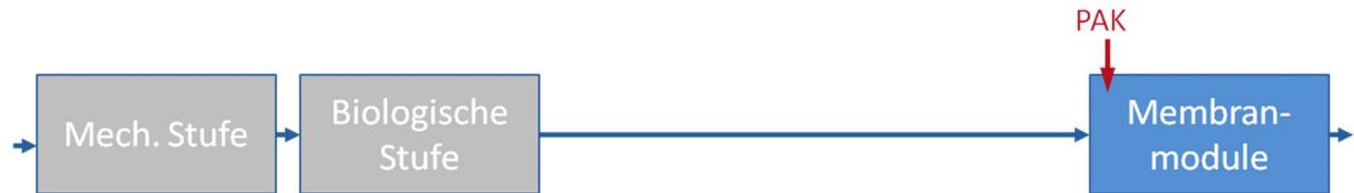
**Abbildung 5-7: Schematische Darstellung der PAK-Dosierung vor Membranmodulen**
