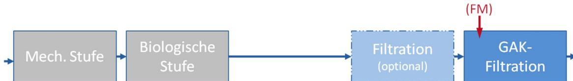
**Abbildung 5-4: Schematische Darstellung der Einbindung einer GAK-Filtration in den bestehenden Klärprozess (2015b)**
