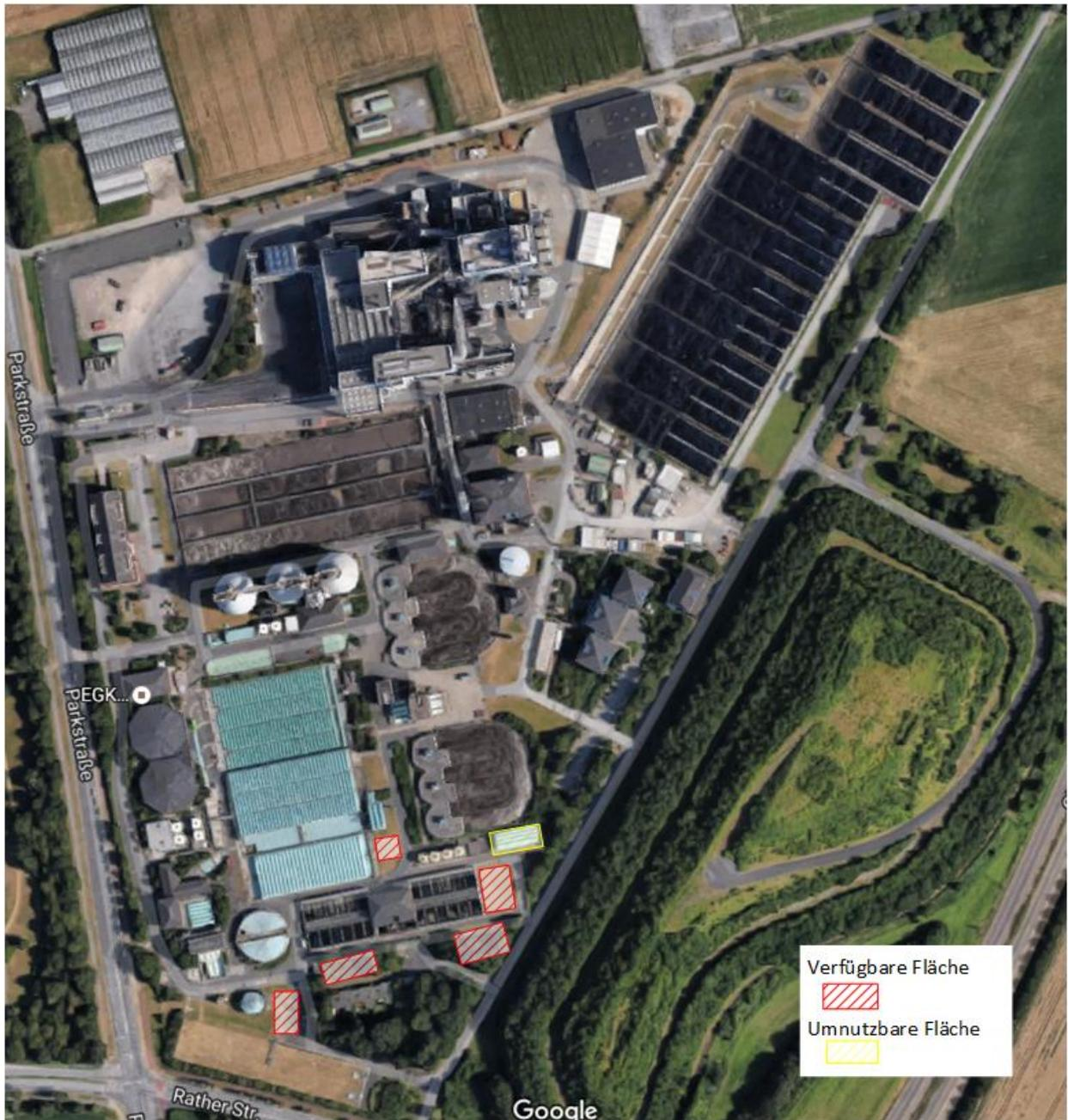
**Abbildung 6-1: Potentielle Fläche zum Bau einer Stufe zur Mikroschadstoffelimination im Bereich der Filtration auf dem Klärwerk Krefeld (ELWAS-WEB, 2016)**
