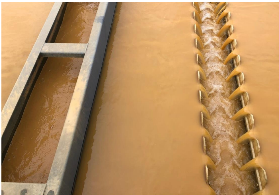
Abbildung A-13: Feldversuch in Blessem am 03.09.2019 um 13:15; Unzureichende Klärung des KWW bei 125 t/h Rohstoffaufgabe und 360 m 3 /h Waschwasser
