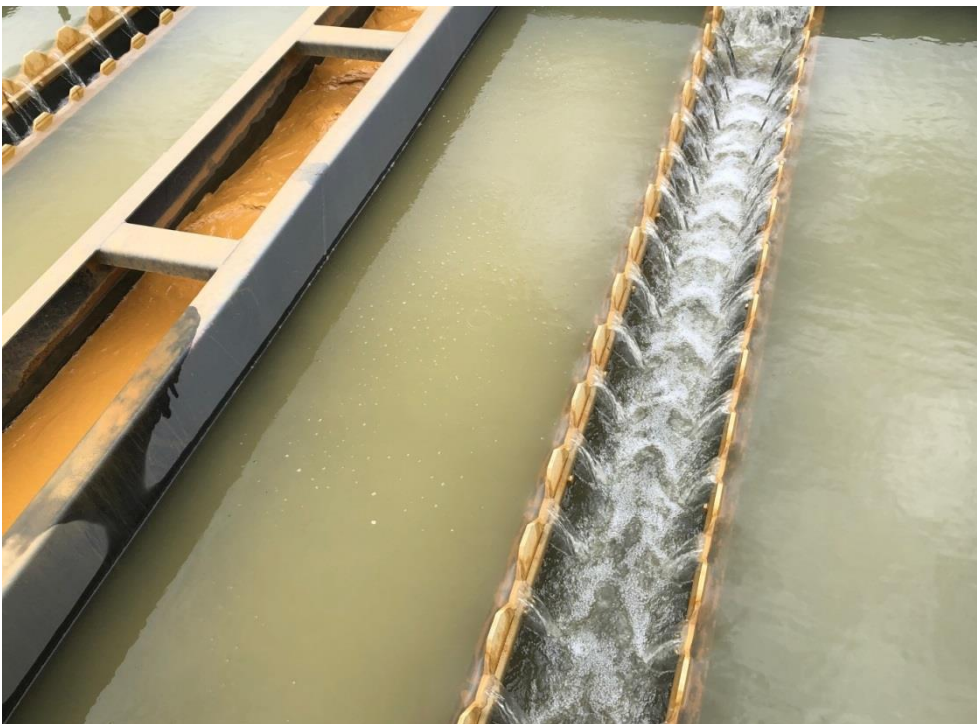
Abbildung A-12: Feldversuch in Blessem am 03.09.2019 um 12:39; Gute Klärung des KWW bei 100 t/h Rohstoffaufgabe und 360 m 3 /h Waschwasser
