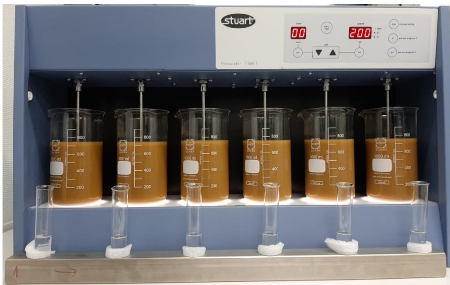
Abbildung 3-1: Flokkulator SW6 der Fa. Stuart Equipment und Reagenzglasalterung zum simultanen Zugabe des FM
