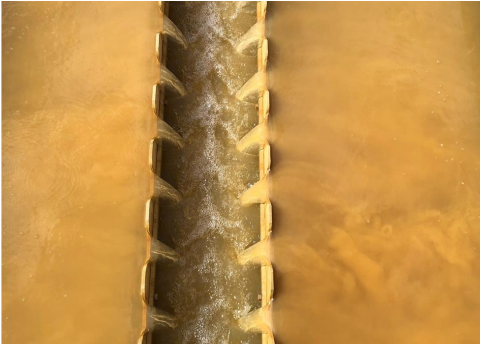
Abbildung A-11: Feldversuch in Blessem am 03.09.2019 um 11:37; Durchbruch der Flocken am Überlauf des Schrägklärers
