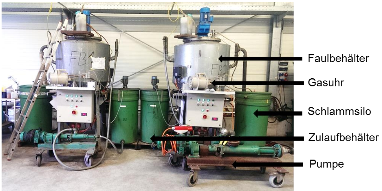
Abbildung 3 Halbtechnische Faulbehälter in der Versuchshalle des Technikums
