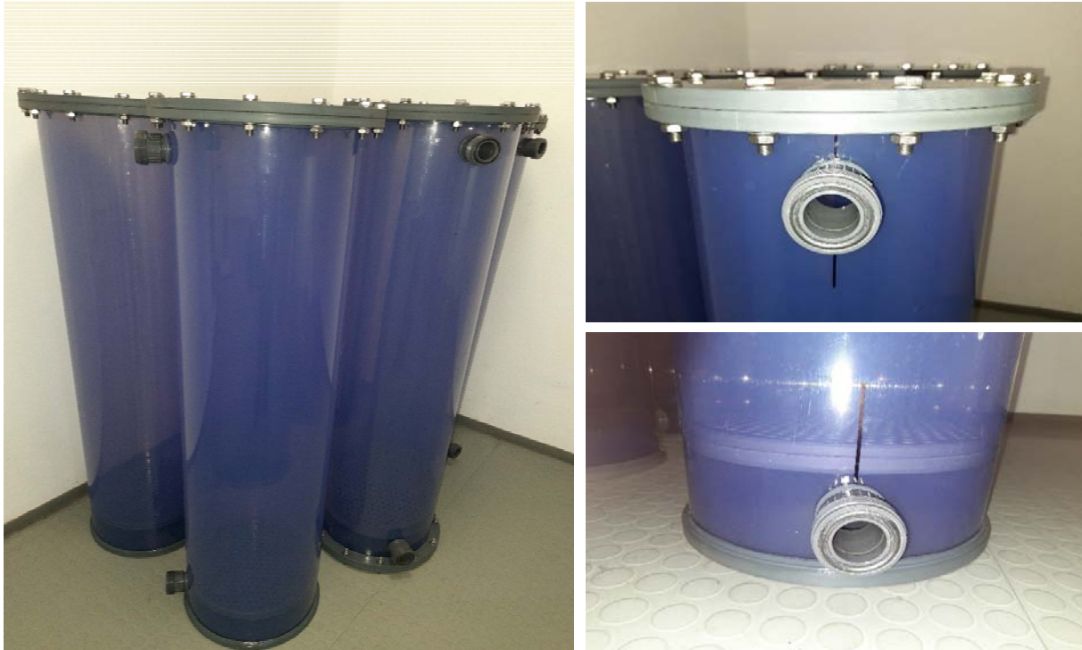
Abbildung 3: Reaktoren (links) und Detailansichten der Reaktoren: Ablauf (oben rechts) und Zulauf (unten rechts).
