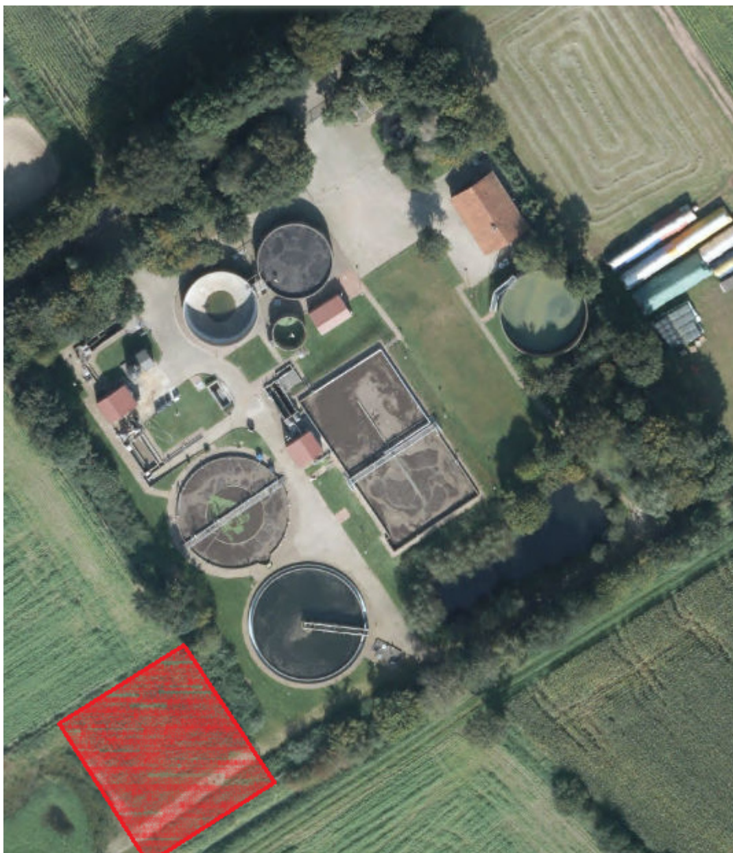
Abbildung 8.1: Ausgewählte Fläche für die 4. Reinigungsstufe auf der Kläranlage (verändert und ergänzt nach ELWAS, 2017)
