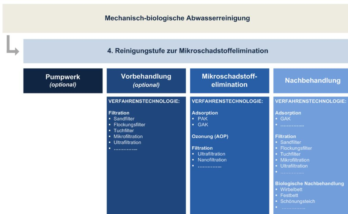
**Abbildung 5-1: Verfahrensschritte zur Mikroschadstoffelimination**
