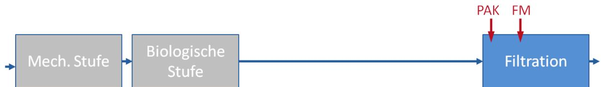
**Abbildung 5-6: Schematische Darstellung der PAK-Dosierung vor der abschließenden Abwasserfiltration (KOM-M.NRW 2015c)**
