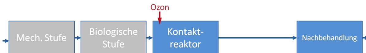
**Abbildung 5-2: Schematische Darstellung der Einbindung einer Ozonung in den bestehenden Klärprozess (KOM-M.NRW 2015c)**
