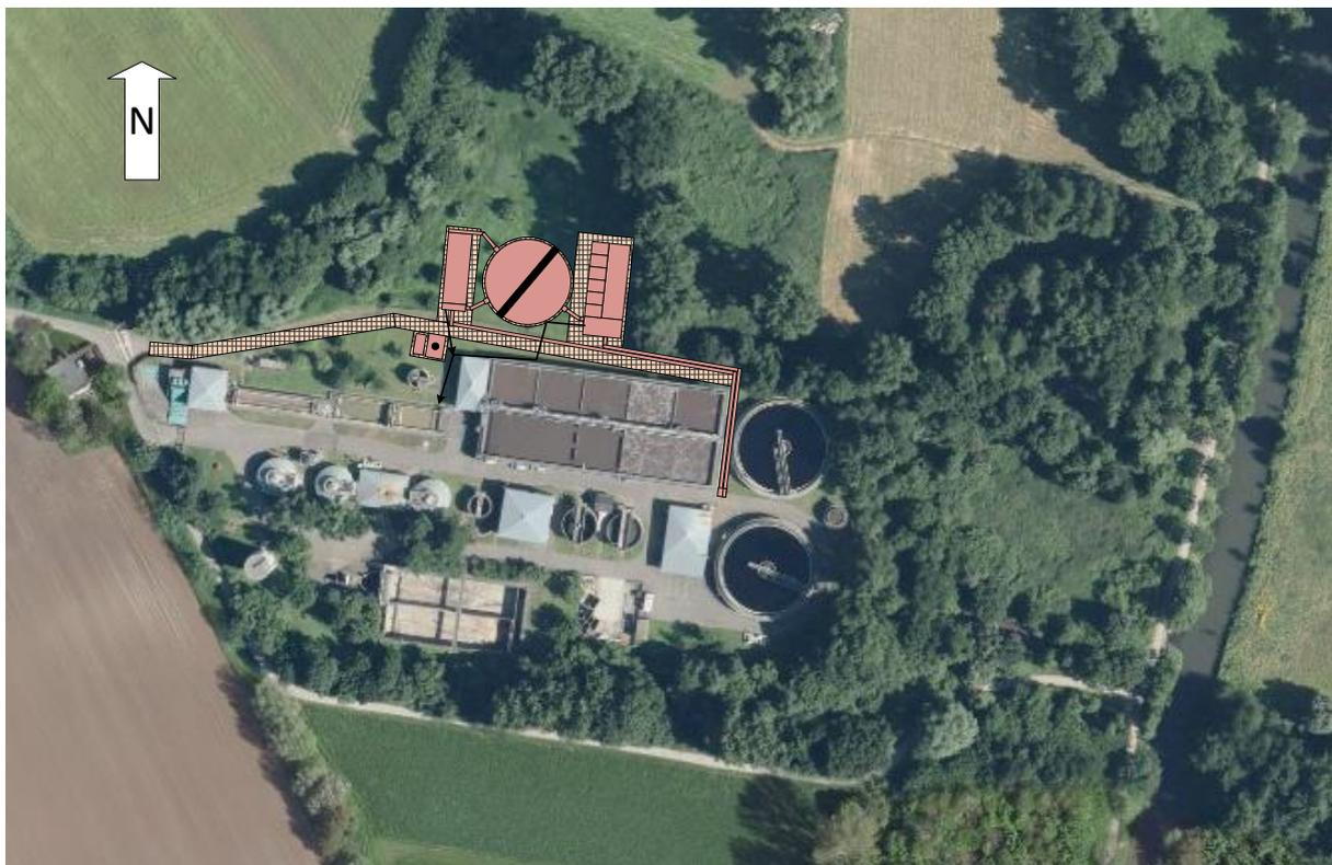
Abbildung 35: Lageskizze PAK-Stufe (Vollstrom)
