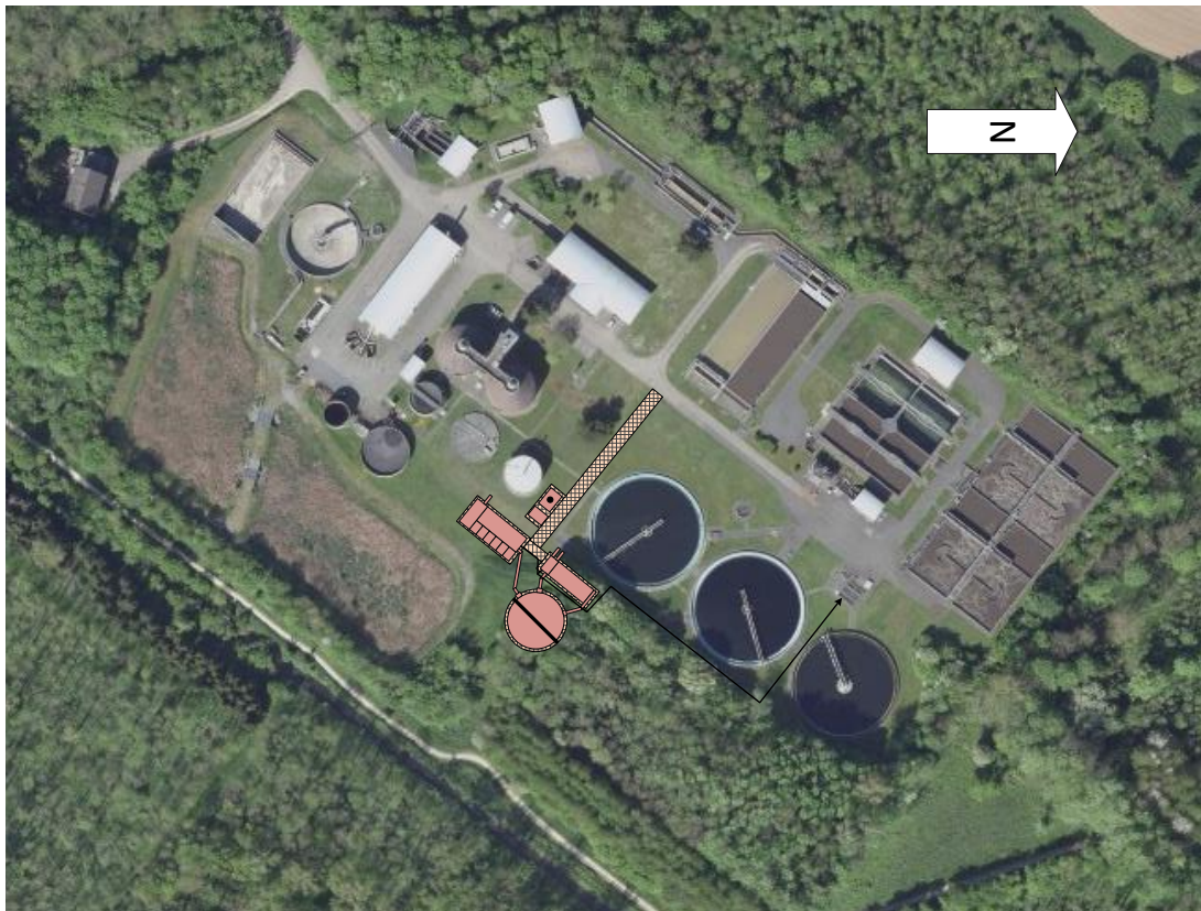
Abbildung 37: Lageskizze PAK-Stufe (Teilstrombehandlung nur Grevenbroich)
