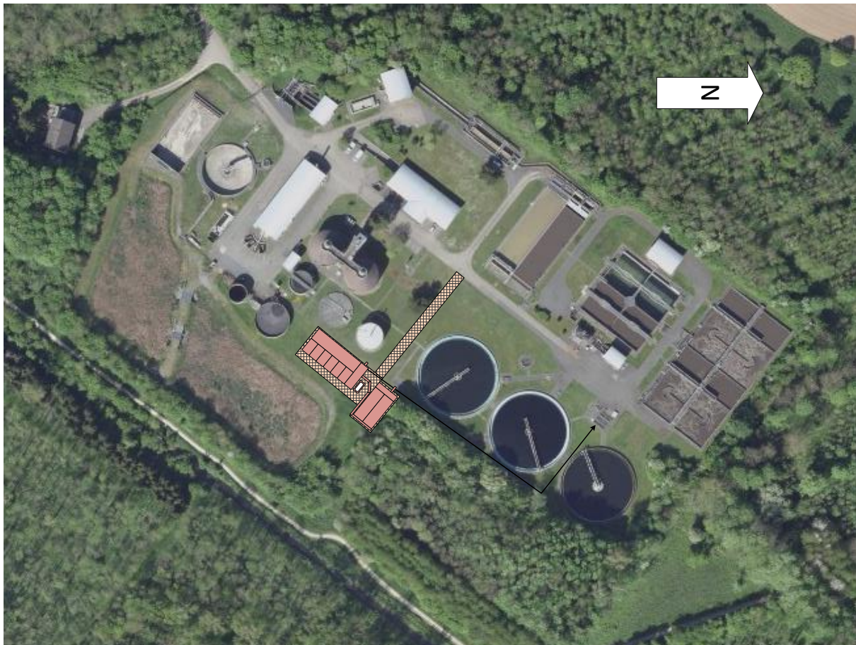
Abbildung 43: Lageskizze Ozonbehandlung (Vollstromverfahren)
