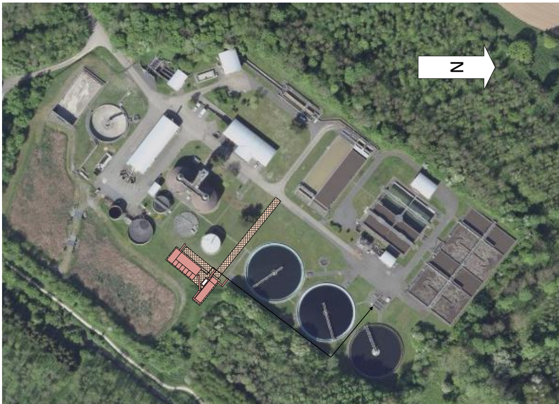
Abbildung 45: Lageskizze Ozonbehandlung (Teilstrom, nur Grevenbroich)
