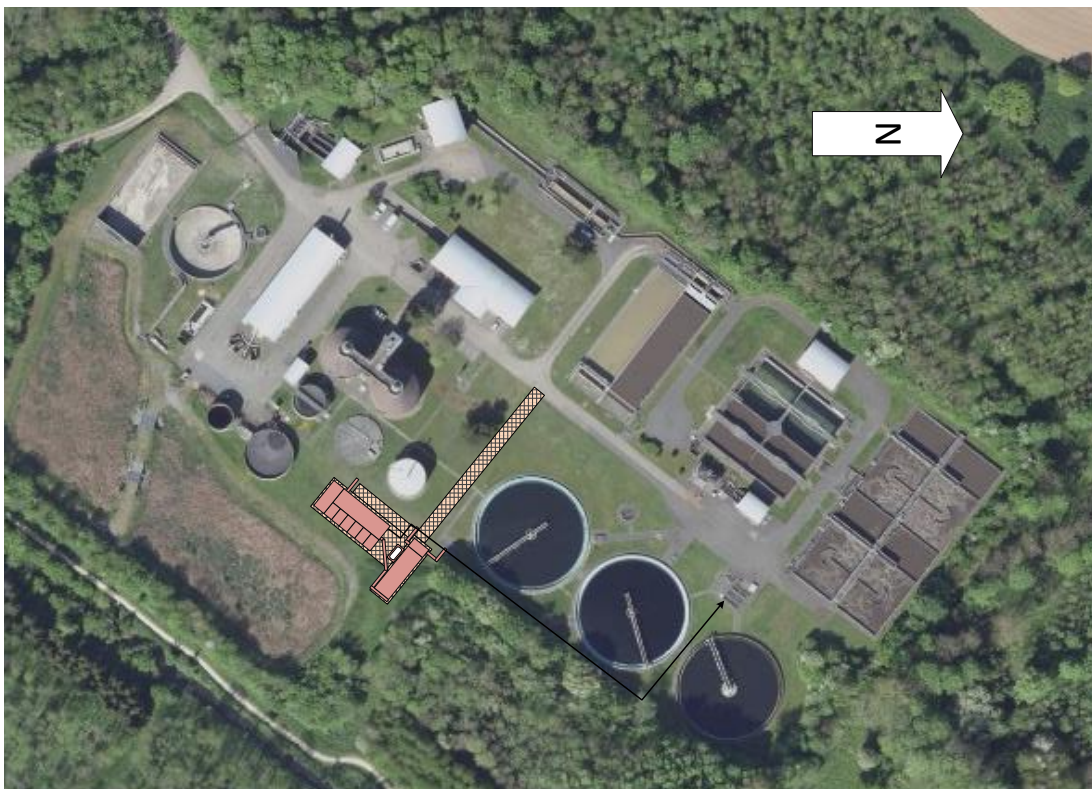
Abbildung 46: Lageskizze Ozonbehandlung (Teilstrom, Grevenbroich mit Wevelinghoven)
