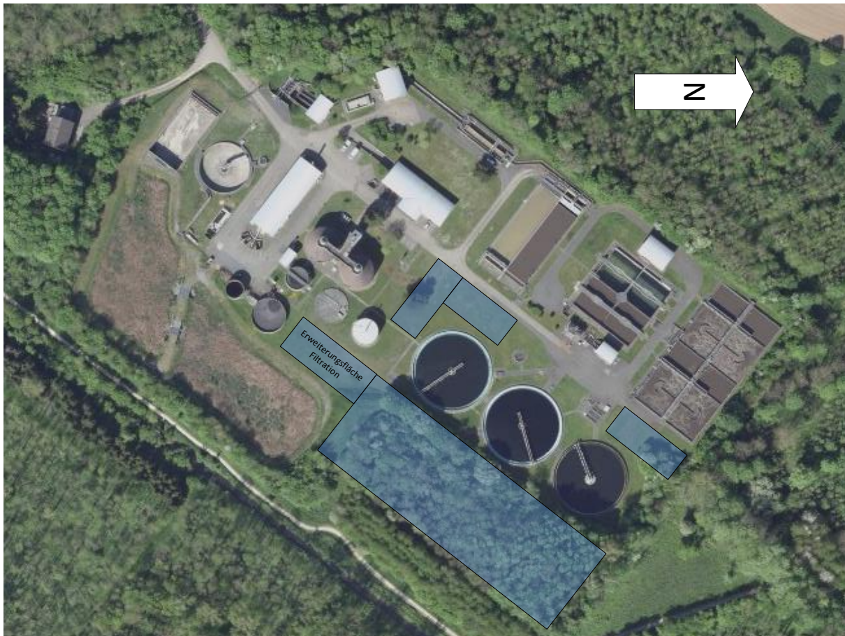
Abbildung 33: Erweiterungsflächen für die 4. Reinigungsstufe
