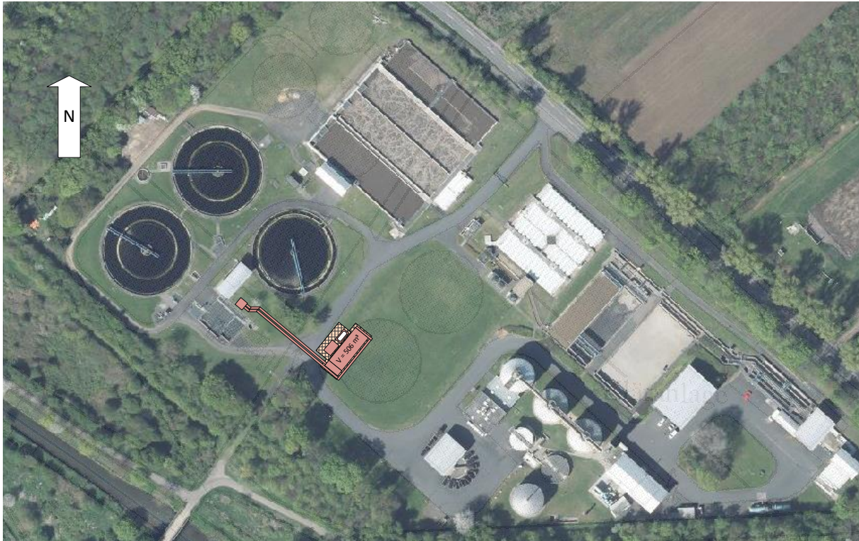
Abbildung 16: Lageskizze Ozonbehandlung (Teilstrom)
