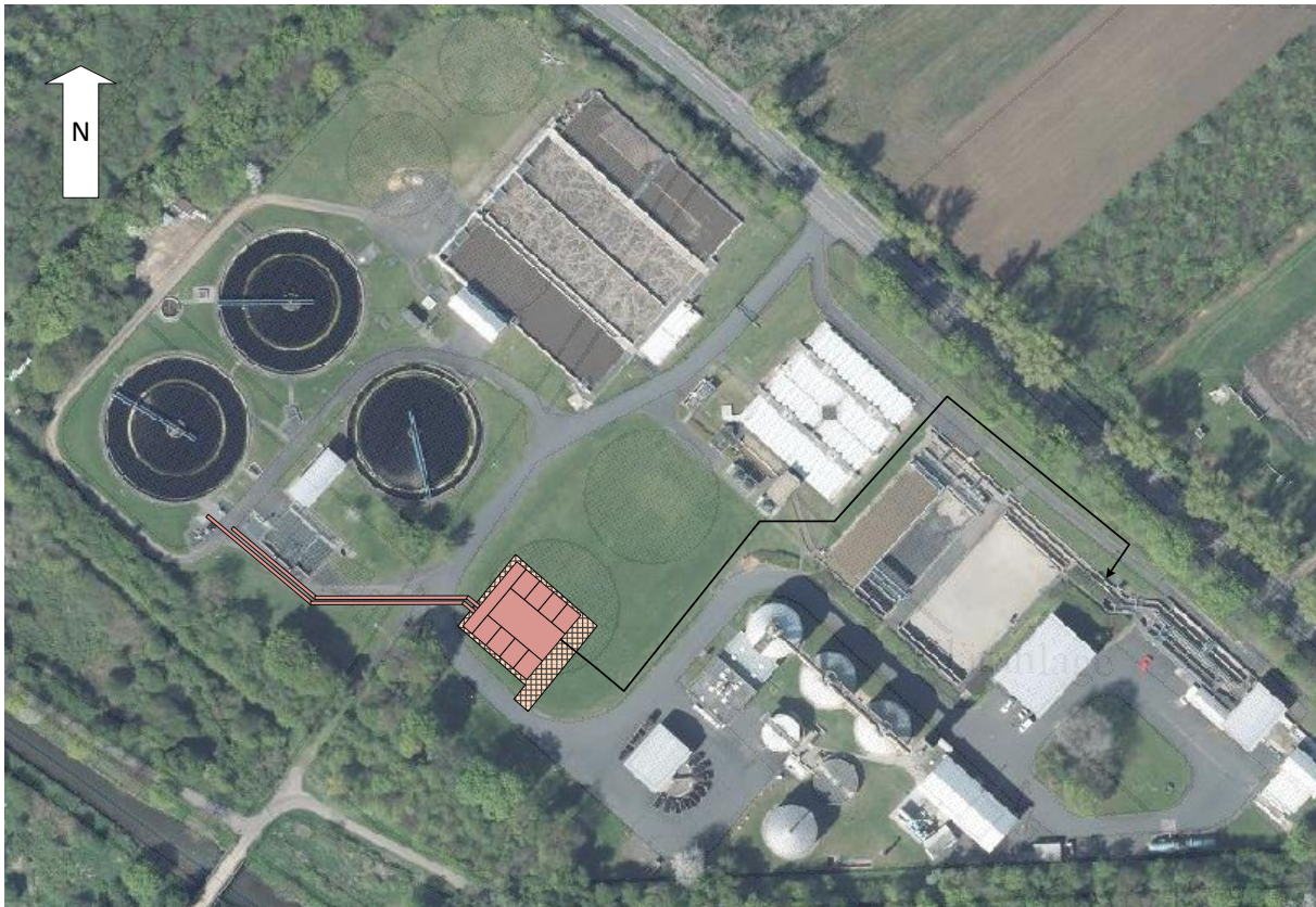
Abbildung 40: Lageskizze GAK-Filtration (Teilstrom)
