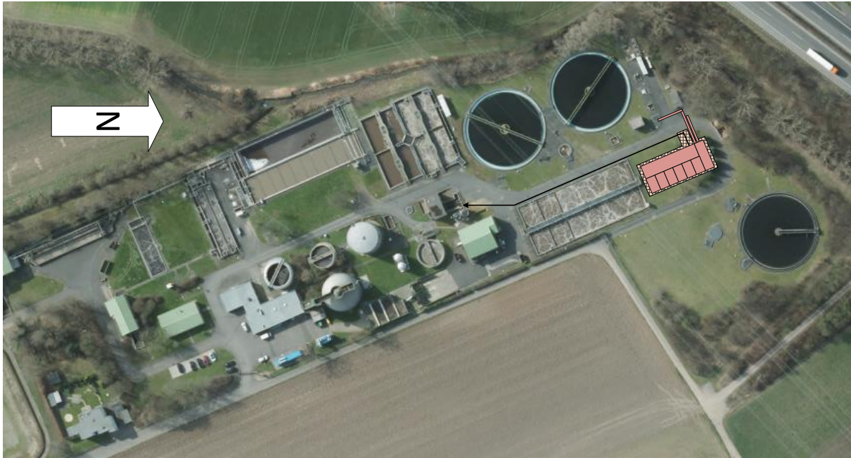
Abbildung 13: Lageskizze GAK-Filtration (Teilstrom)
