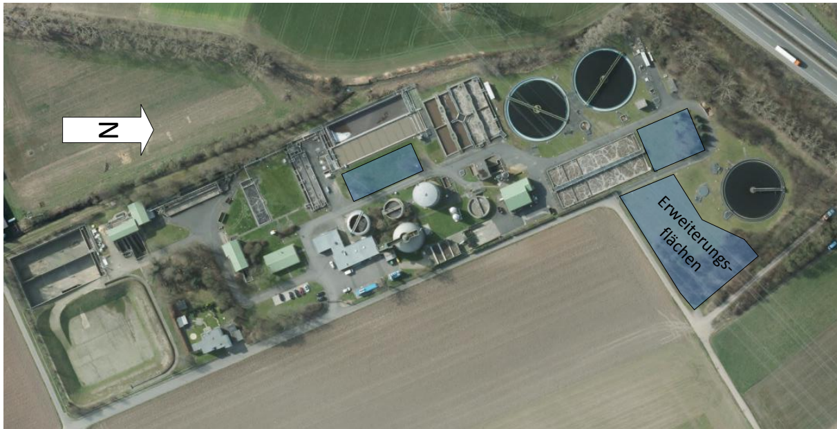
Abbildung 33: Erweiterungsflächen für die 4. Reinigungsstufe
