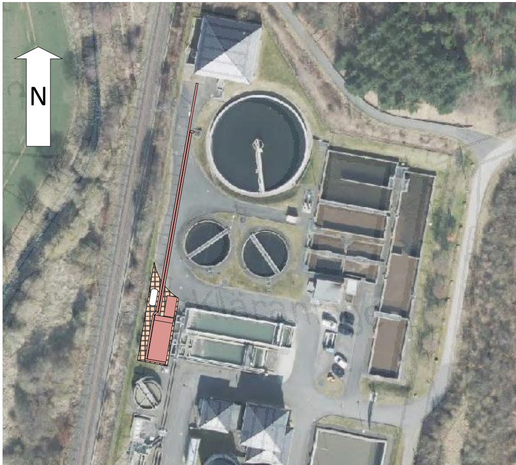
Abbildung 9: Lageskizze Ozonbehandlung (Vollstromverfahren)
