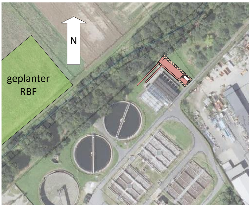
Abbildung 41: Lageskizze Ozonbehandlung (Vollstromverfahren)
