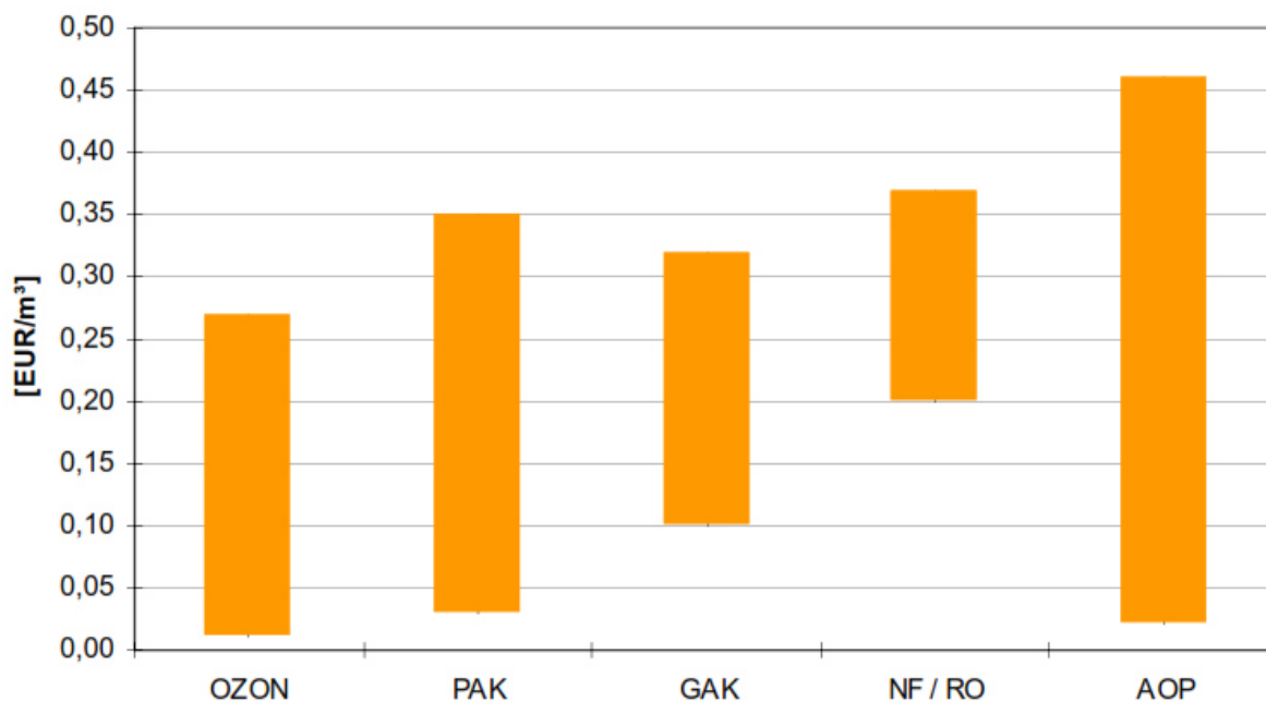
Abbildung 7.22: Bandbreite der spezifischen Kosten (€/m 3 ) der einzelnen Verfahren zur Mikroschadstoffelimination. Teilweise handelt es sich um Betriebskosten, teilweise um Jahreskosten (Bolle, 2011)
