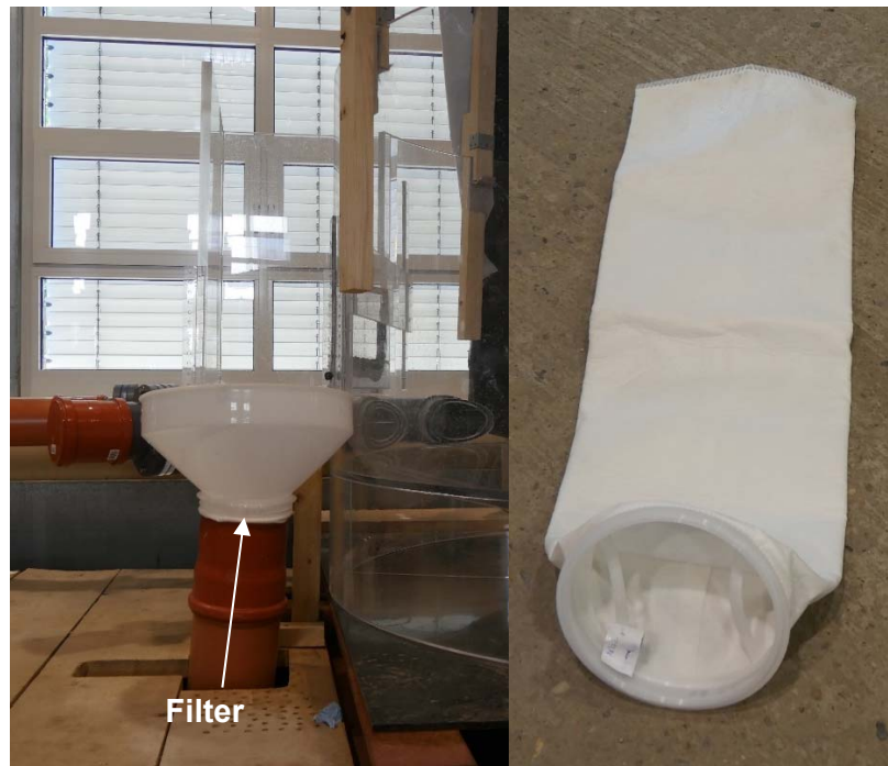
Bild 6.21: links: Lage des Filters im eingebauten Zustand; rechts: Filter in der Ansicht
