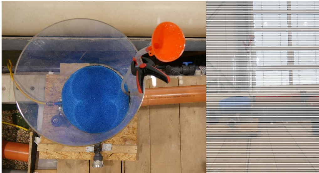
Bild 6.20: Zugabeort des Versuchsmaterials über eine Trichter-Vorrichtung, links: Draufsicht; rechts: Ansicht
