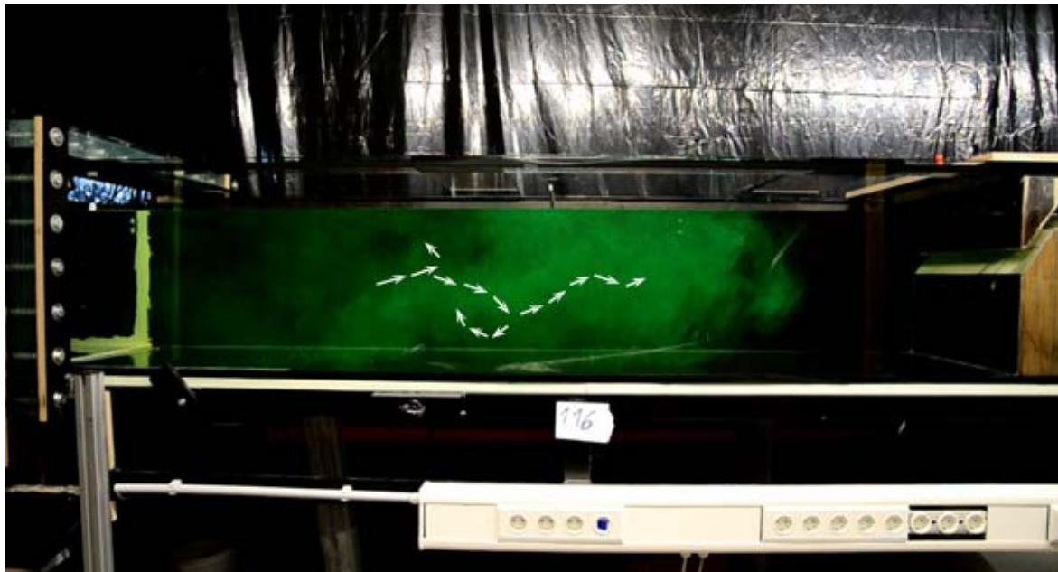
Bild 5.3: Momentaufnahme des Tracerversuchs der Grundvariante im Querschnitt
