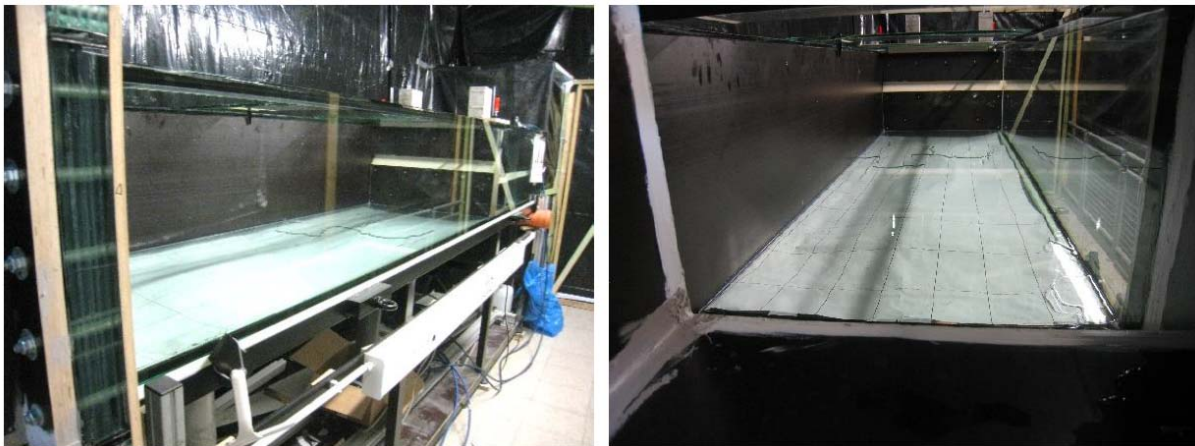
Bild 4.5: links: Außenansicht Glasbecken; rechts: Sedimentationskammer
