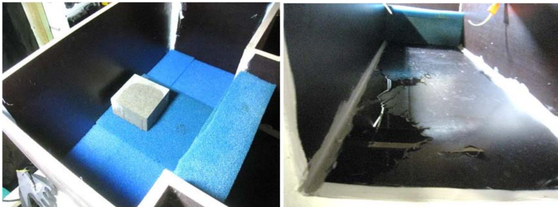
Bild 4.4: links: Quelltopf mit Turbulenzgitter; rechts: Einlaufgerinne mit Turbulenzgitter
