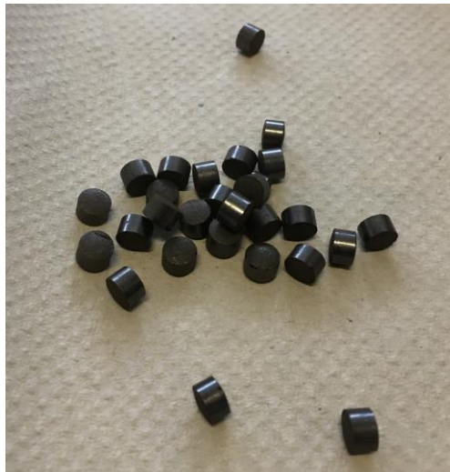
Abbildung 11: Kupferbasierte Katalysatorpellets für die Methanolsynthese
