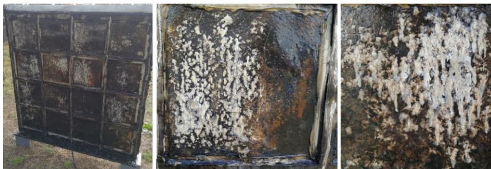
Abbildung 10: Gesamtansicht (links) und Nahaufnahmen (Mitte und rechts) der Ablagerungen auf den Kathoden
