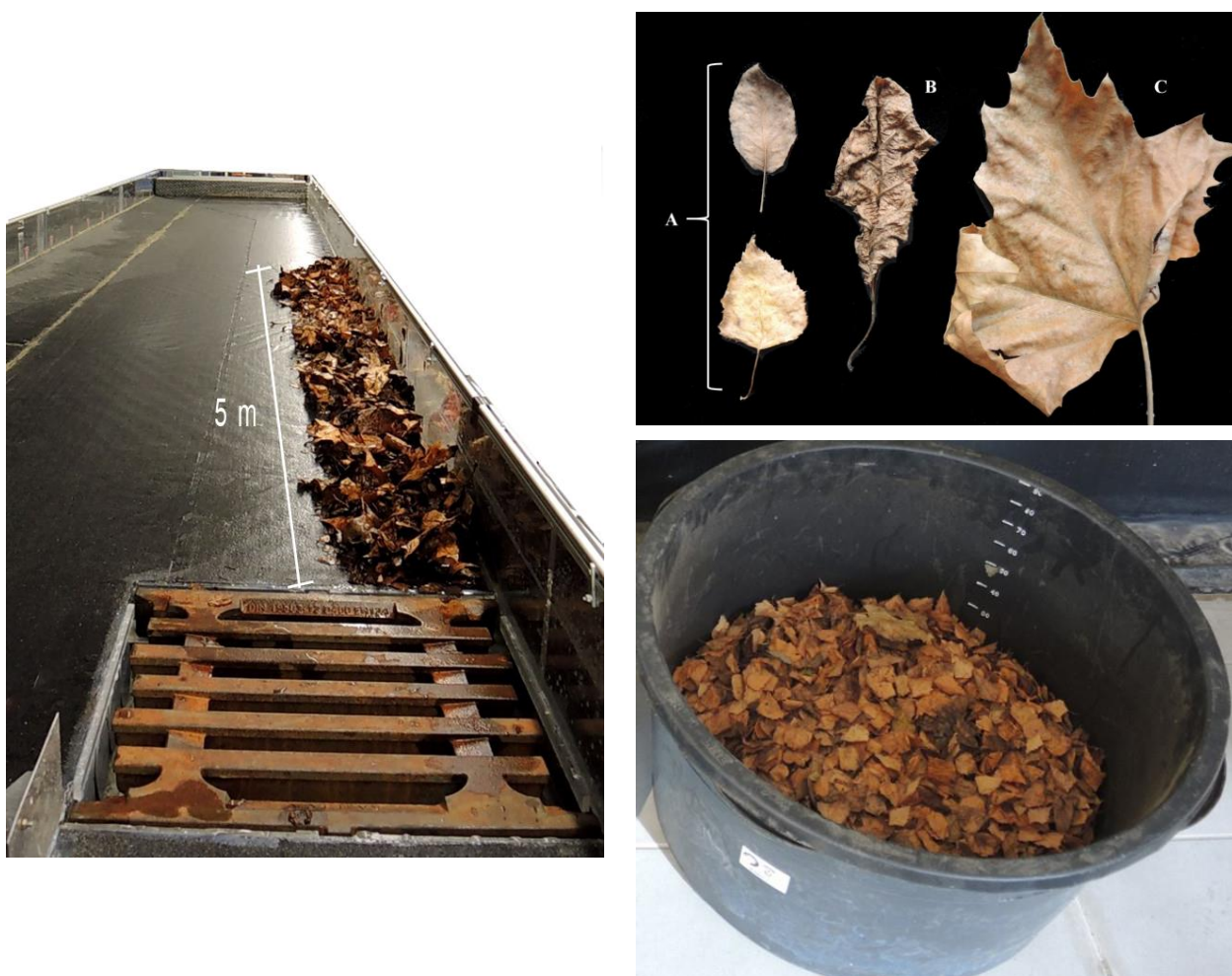
Abbildung 4: Versuchsaufbau mit Laub (links: Initialzustand, rechts oben: Buchenblätter (A), Eichenblätter (B) und Platanenblätter (C), rechts unten: Lagerung der getrockneten Blätter)
