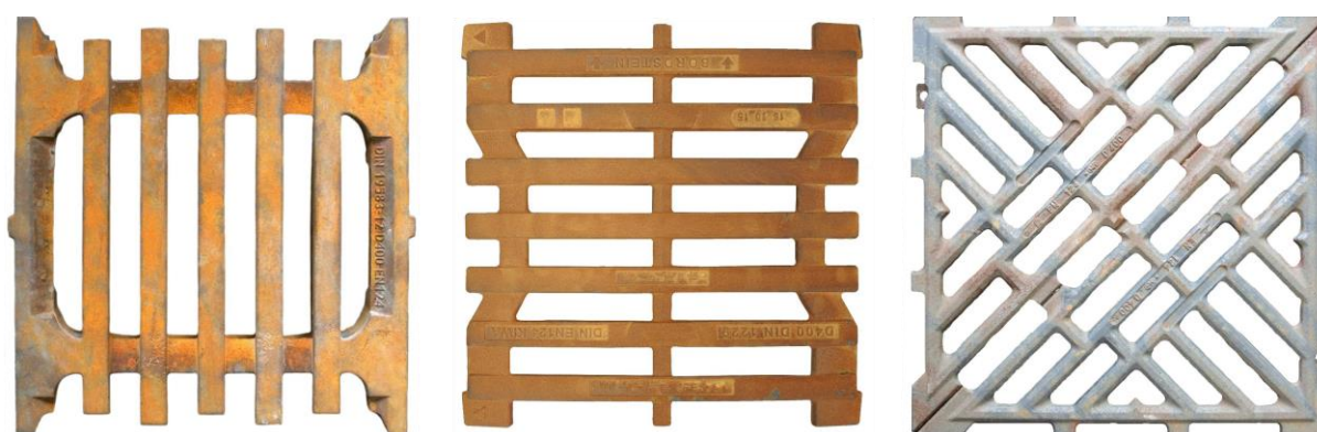
Abbildung 3: Untersuchte Straßenablauf-Aufsätze, Fließrichtung von links nach rechts (links: Querstreben (PA_Q), mitte: Längstreben (PA_L), rechts: Diagonalstreben (PA_D))
