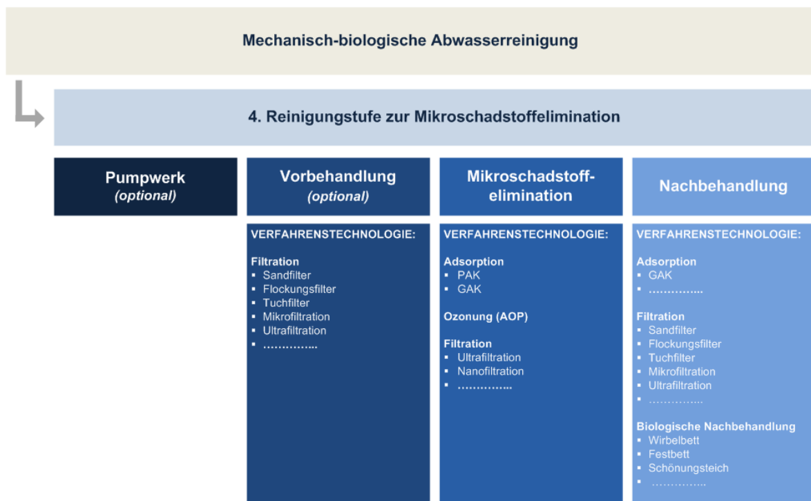
Abbildung 5-1: Verfahrensschritte zur Mikroschadstoffelimination
