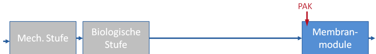
Abbildung 5-7: Schematische Darstellung der PAK-Dosierung vor Membranmodule (nach KOM-M.NRW, 2016)
