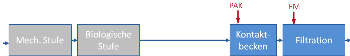
Abbildung 5-8: Schematische Darstellung der PAK-Dosierung in den Zulauf zur Filtration mit separatem Kontaktbecken (Flockungsraum) (nach KOM-M.NRW, 2016)
