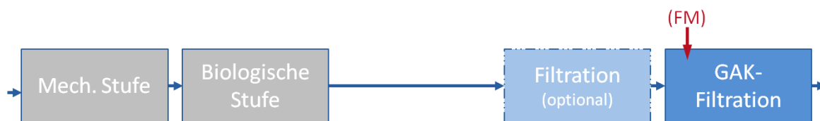
Abbildung 5-4: Schematische Darstellung der Einbindung einer GAK-Filtration in den bestehenden Klärprozess (KOM-M.NRW, 2016)
