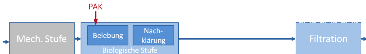
Abbildung 5-9: Schematische Darstellung der simultanen PAK-Dosierung im Belebungsbecken (nach KOM-M.NRW, 2016)
