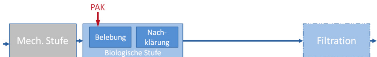
Abbildung 5-9: Schematische Darstellung der simultanen PAK-Dosierung im Belebungsbecken
