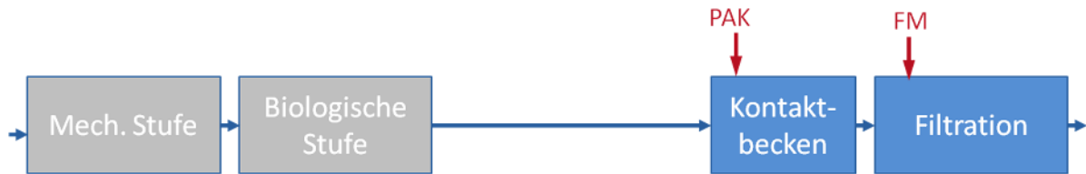
Abbildung 5-8: Schematische Darstellung der PAK-Dosierung in den Zulauf zur Filtration mit separatem Kontaktbecken (Flockungsraum) nach Herbst und Hilbig (2013)
