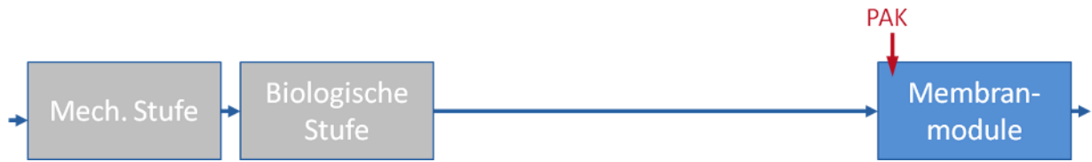
Abbildung 5-7: Schematische Darstellung der PAK-Dosierung vor Membranmodulen
