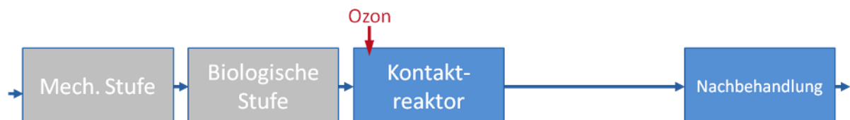
Abbildung 5-2: Schematische Darstellung der Einbindung einer Ozonung in den bestehenden Klärprozess
