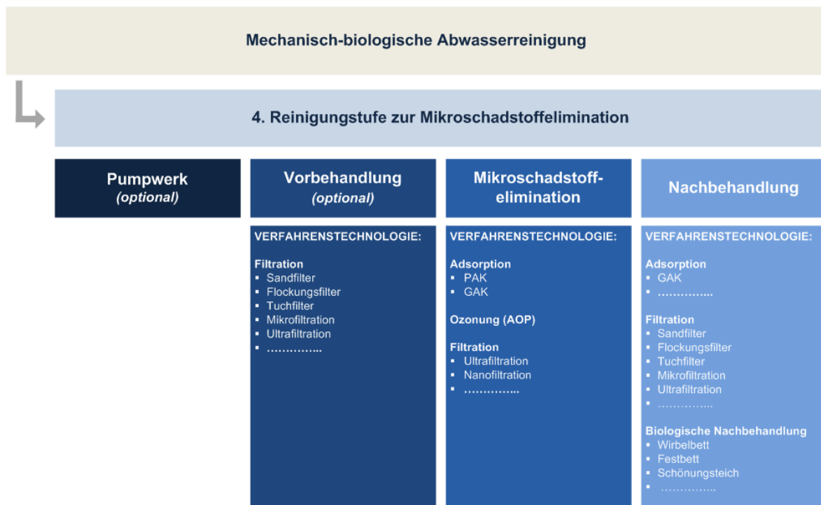
Abbildung 5-1: Verfahrensschritte zur Mikroschadstoffelimination
