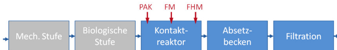
Abbildung 5-5: Schematische Darstellung der PAK-Dosierung in einer separaten Adsorptionsstufe
