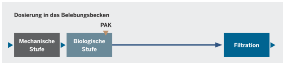
Abb. 4.2.4: Schematische Darstellung PAK-Dosierung direkt in die Belebung [KOMPETENZ-ZENTRUM MIKROSCHADSTOFFE NRW, 2016]
