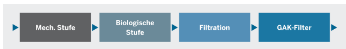
Abb. 4.3.1: Schematische Darstellung der Einbindung einer GAK-Filtration [KOMPETENZ-ZENTRUM MIKROSCHADSTOFFE NRW, 2016]
