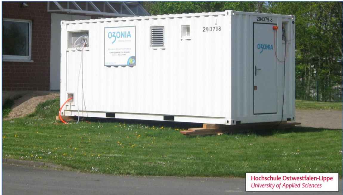
Abbildung 18: Halbtechnische Ozon-Versuchsanlage (Containerbauweise) der Fa. Ozonia – Degrémont Technologies Ltd, Dübendorf (CH) am Standort der ZKA Detmold
