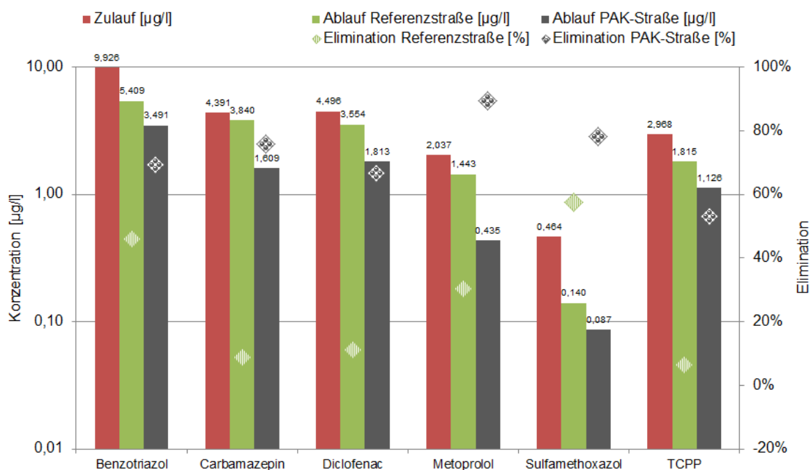
Abbildung 2-5: Spurenstoffkonzentration im Zulauf und Ablauf der Referenz- und PAK-Straße ( 10 \text{ mg}_{\text{PAK}}/\text{l}_{\text{Zu}} ) sowie Eliminationen ( n = 9 )
