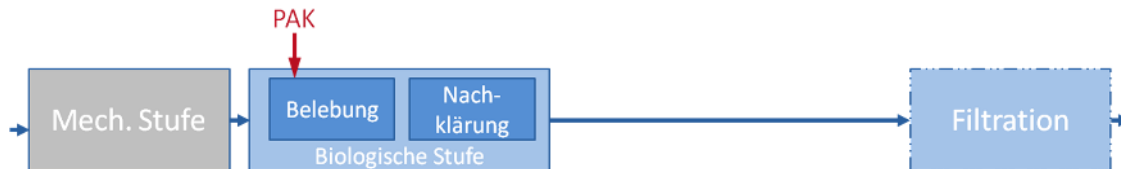
Abbildung 5.9: Schematische Darstellung der simultanen PAK-Dosierung im Belebungsbecken (KOM-M.NRW, 2015b)
