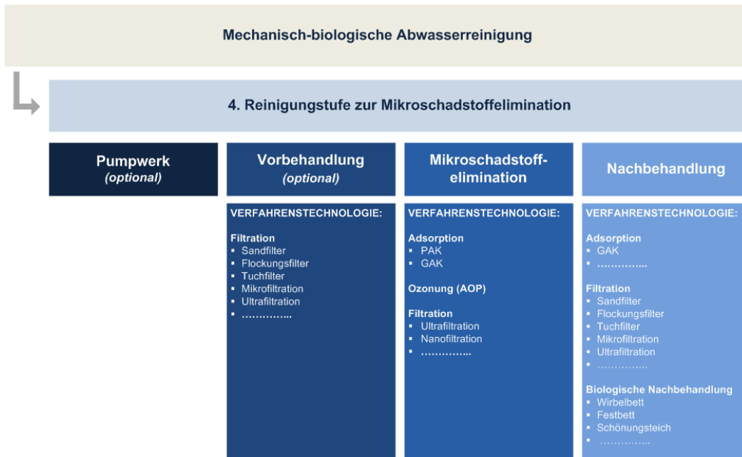
Abbildung 5.1: Verfahrensschritte zur Mikroschadstoffelimination
