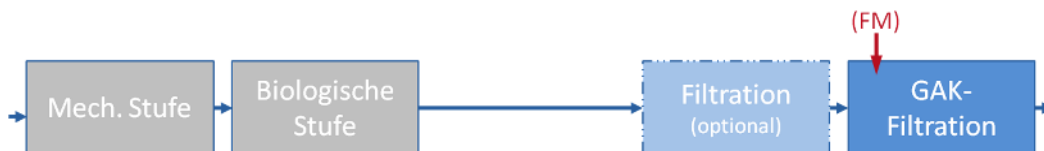
Abbildung 5.4: Schematische Darstellung der Einbindung einer GAK-Filtration in den bestehenden Klärprozess (KOM-M.NRW, 2015b)
