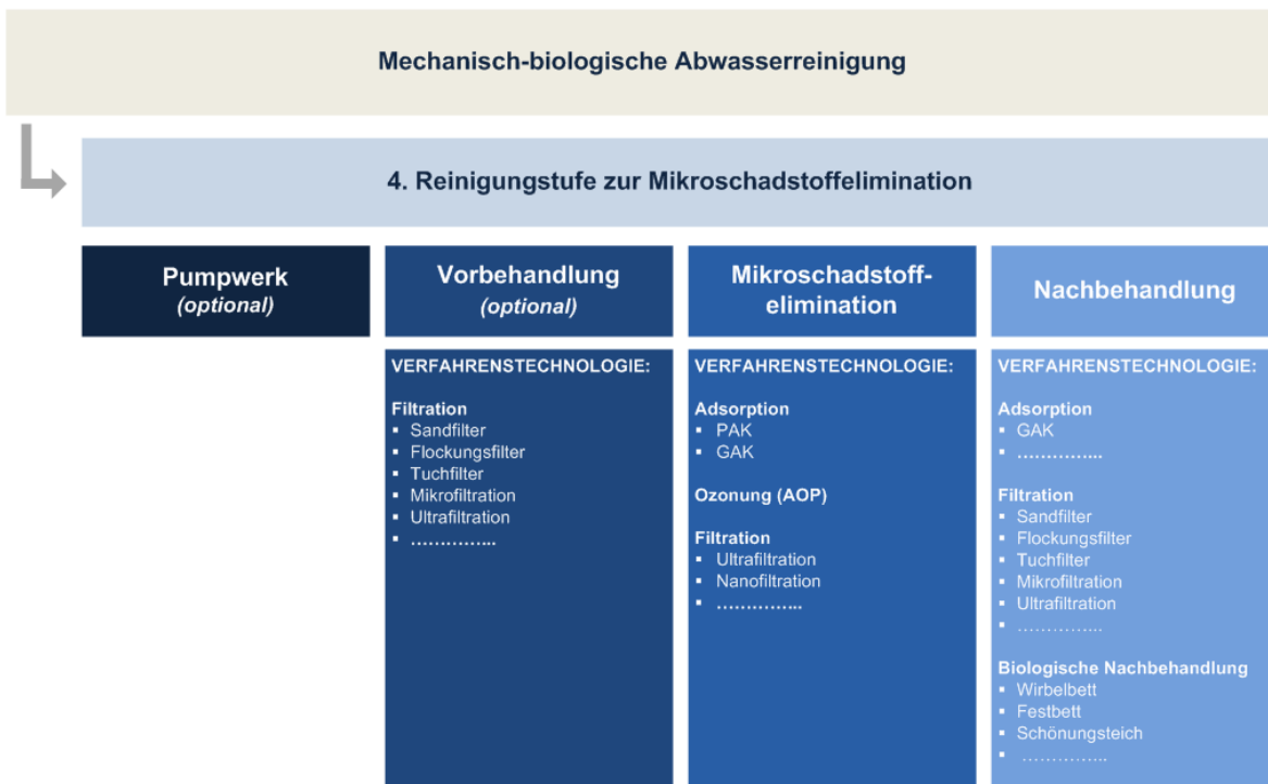
Abbildung 5.1: Verfahrensschritte zur Mikroschadstoffelimination
