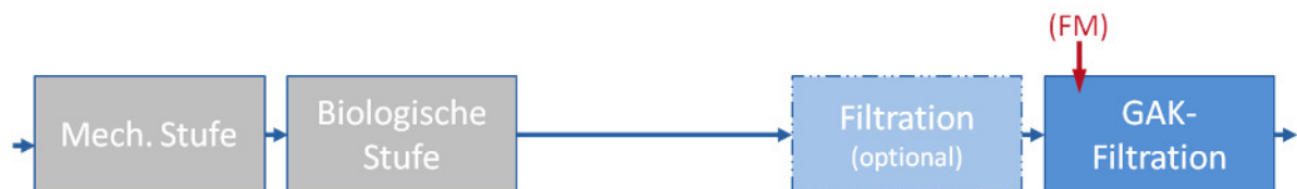
Abbildung 5.4: Schematische Darstellung der Einbindung einer GAK-Filtration in den bestehenden Klärprozess (KOM-M.NRW, 2015b)
