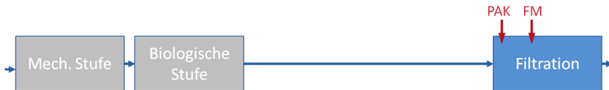
Abbildung 5.6: Schematische Darstellung der PAK-Dosierung vor der abschließenden Abwasserfiltration (KOM-M.NRW, 2015b)
