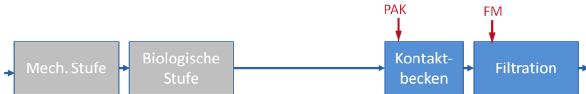
Abbildung 5.8: Schematische Darstellung der PAK-Dosierung in den Zulauf zur Filtration mit separatem Kontaktbecken (Flockungsraum) (nach Herbst und Hilbig, 2012)
