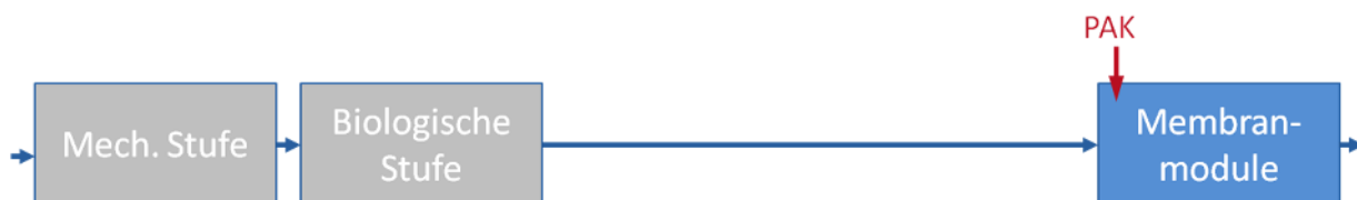
Abbildung 5.7: Schematische Darstellung der PAK-Dosierung vor Membranmodule
