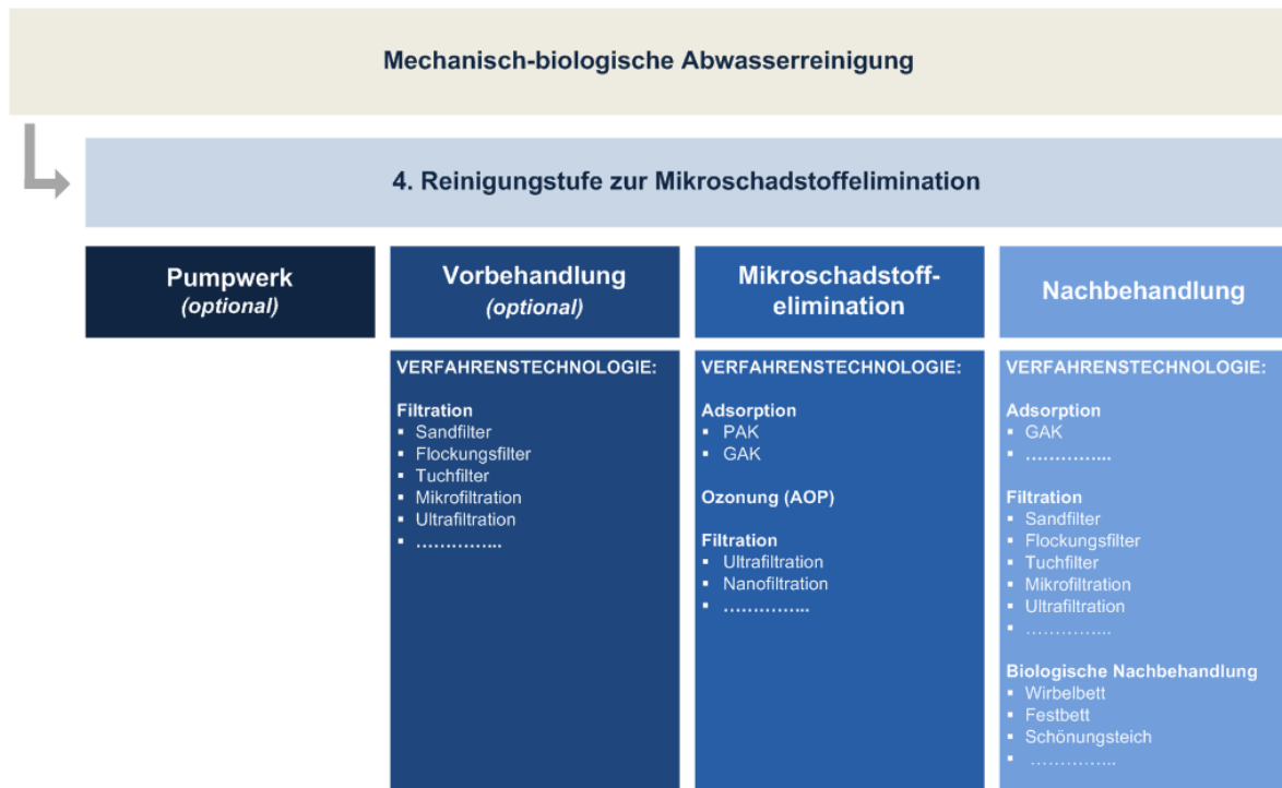
Abbildung 3-1: Verfahrensschritte zur Mikroschadstoffelimination
