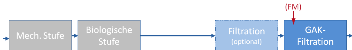
Abbildung 3-4: Schematische Darstellung der Einbindung einer GAK-Filtration in den bestehenden Klärprozess (KOM-M.NRW, 2015a)
