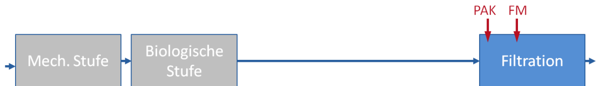
Abbildung 3-6: Schematische Darstellung der PAK-Dosierung vor der abschließenden Abwasserfiltration (KOM-M.NRW, 2015a)
