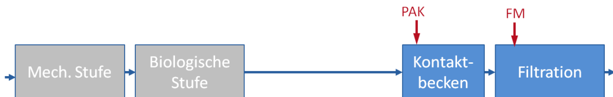
Abbildung 3-8: Schematische Darstellung der PAK-Dosierung in den Zulauf zur Filtration mit separatem Kontaktbecken (Flockungsraum) (nach Herbst und Hilbig, 2012)
