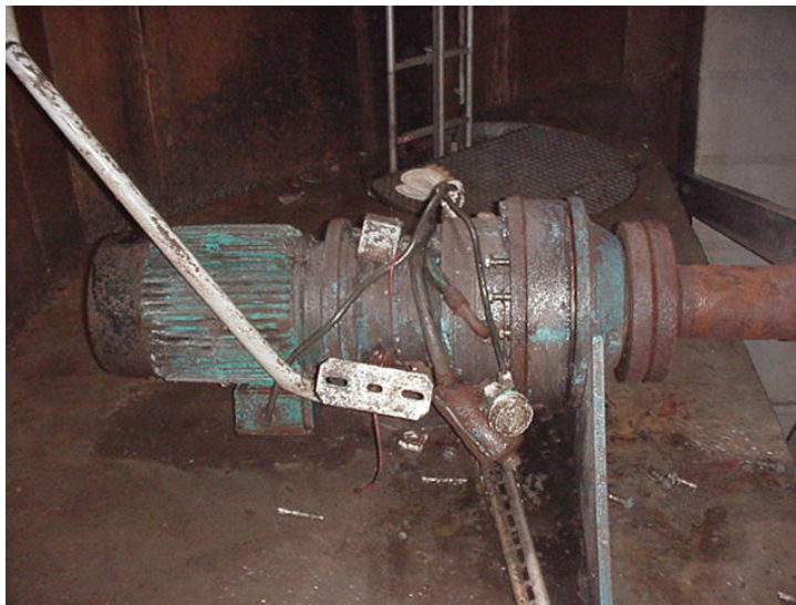
Bild 7.1: Generator-Getriebe-Einheit am Wasserrad nach dem Schadensfall
