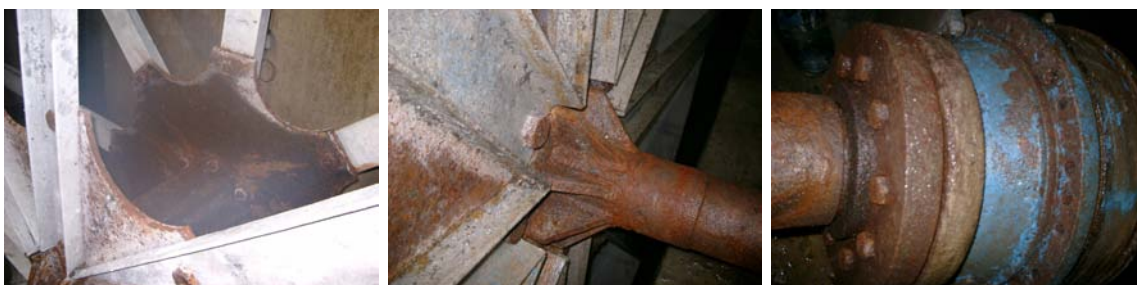
Bild 7.6: Wasserradteile mit starkem Rostbefall nach insgesamt 30 Monaten in Kanalatmosphäre – von links nach rechts – Achse mit Flansch und Tragarmen, Achse mit Tragarmen, Achsen-Getriebeflansch
