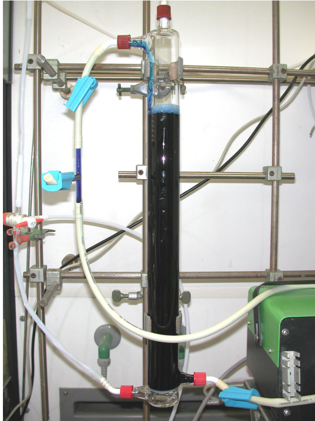
Abbildung 2.9: Entfärbung eines blauen Farbstoffes mit Ozon in einem Blasensäulenreaktor
