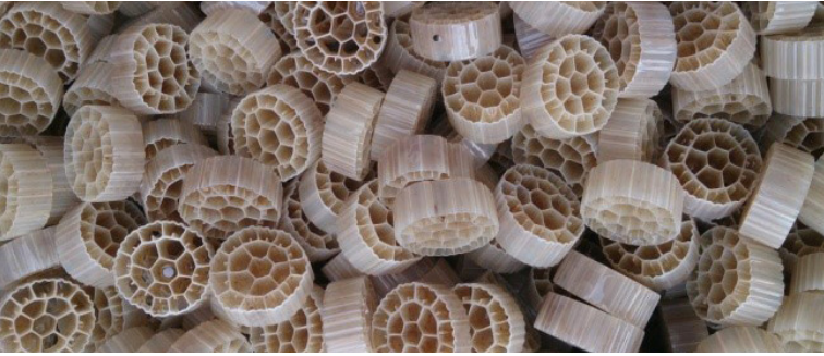
Füllkörper für Bewegtbett-Biofilter mit möglichst großer Oberfläche
