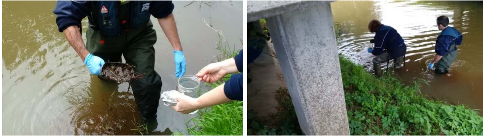
Abbildung 20: Bilder der Sedimententnahme im Umfeld der Grubenwassereinleitung Oeynhaus-Stollen, Bergwerks-KA Püßelbüren
