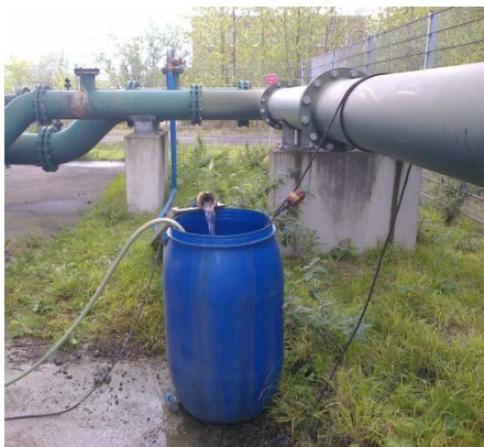
Abbildung 48: Grubenwassermessstellen und Zentrifugenprobenahme Zeche Amalie, Foto LANUV (links) und RAG (rechts)
