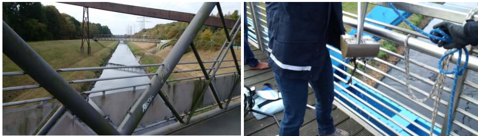
Abbildung 44: Bilder der Sedimententnahme im Umfeld der Grubenwassereinleitungen Zollverein und Prosper Haniel
