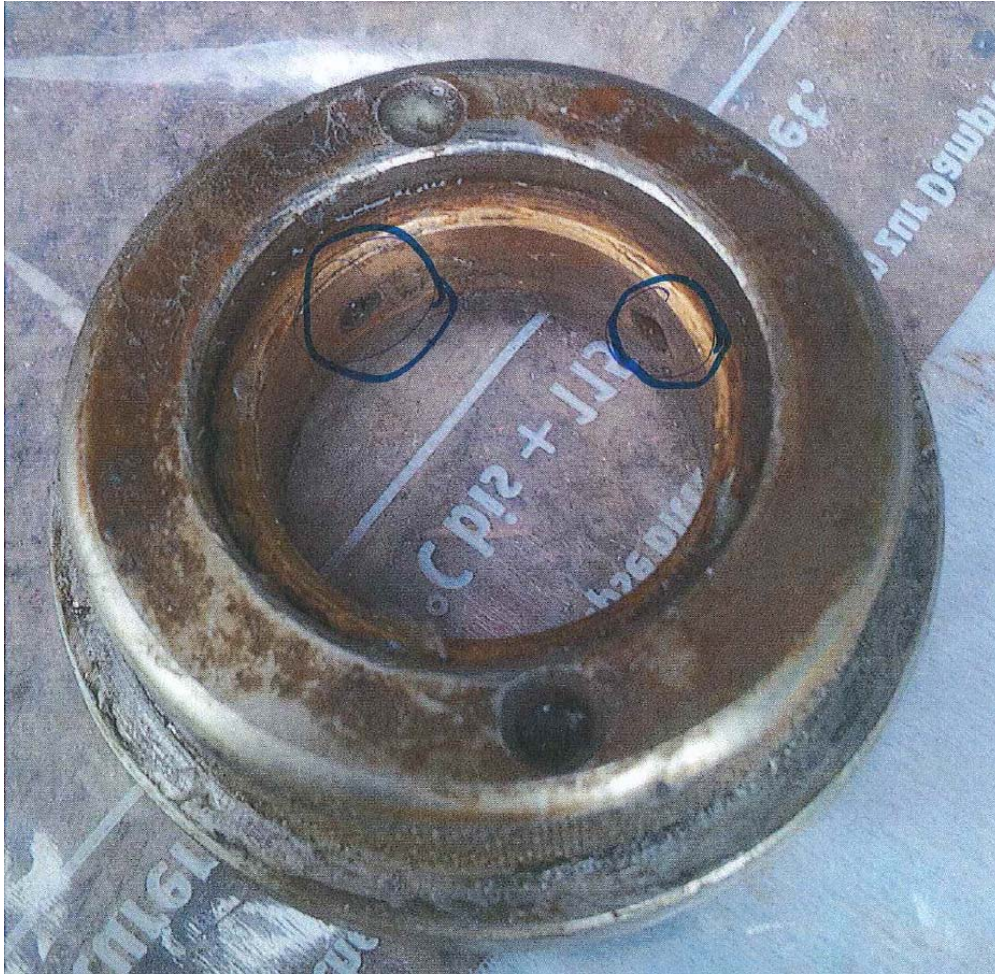
Abbildung 65: Lager der Zentrifuge nach Grubenwasser-Probenahme auf Haus Aden
