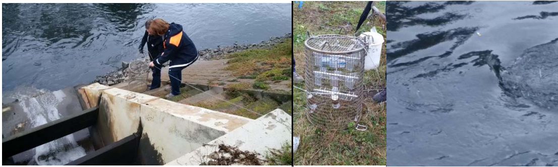
Abbildung 38: Einbringung des Korbes mit den Passivsammlern in die Emscher an der Einleitungsstelle Prosper Haniel
