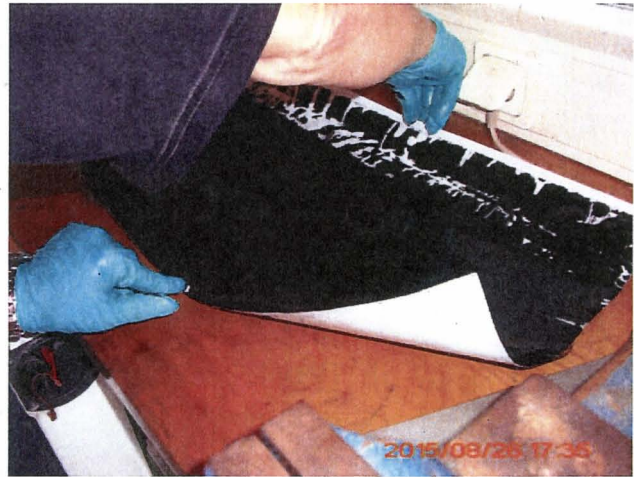
Abbildung 5: gewonnener Schwebstoff aus der Zentrifuge, Teflonfolie nach Entnahme aus dem Rotor
