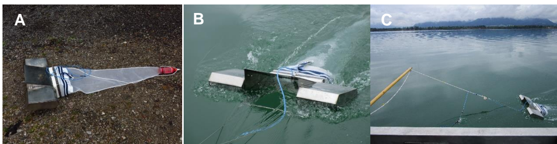
Abb. 1. Fotografien des „MiniManta“-Trawls. (A) Seitenansicht an Land. (B) Vorderansicht im Wasser mit Strömungssensor in der Mitte der Öffnung. (C) „MiniManta“-Trawl am Seitenausleger seitlich entlang des Bootes geführt.
