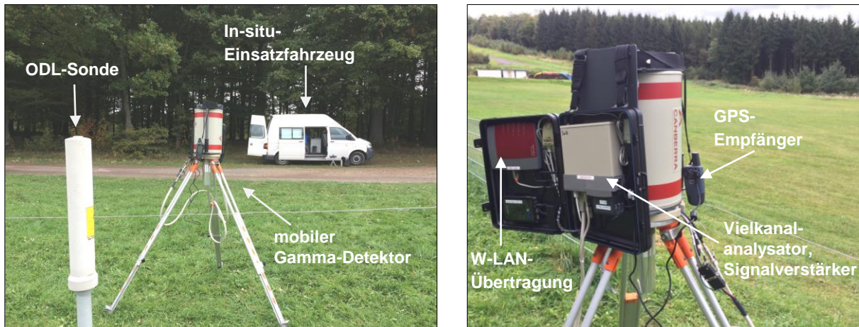
Abbildung 5.6: In-situ-Messung an einer ODL-Sonde bei Siegen.
