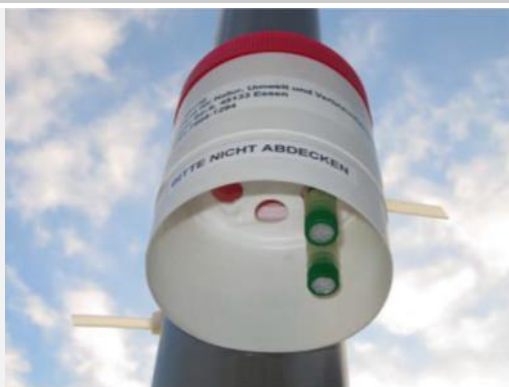
Foto: LANUV: NO 2 -Passivsammler im Schutzgehäuse
