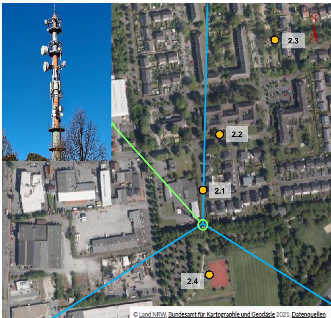
Abbildung 3.2: Ausrichtung der 5G-Sendeantennen und Lage der Messpunkte am Standort 2. Die blauen Linien stellen die horizontale Antennenausrichtung der 5G-Antennen dar, der grüne Kreis den Standort der Basisstation und die gelb ausgefüllten Kreise die Messpunkte.
