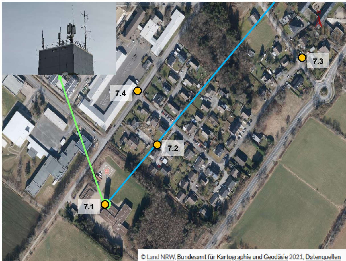
Abbildung 3.7: Ausrichtung der 5G-Sendeantennen und Lage der Messpunkte am Standort 7. Die blauen Linien stellen die horizontale Antennenausrichtung der 5G-Antennen dar, der grüne Kreis den Standort der Basisstation und die gelb ausgefüllten Kreise die Messpunkte.
